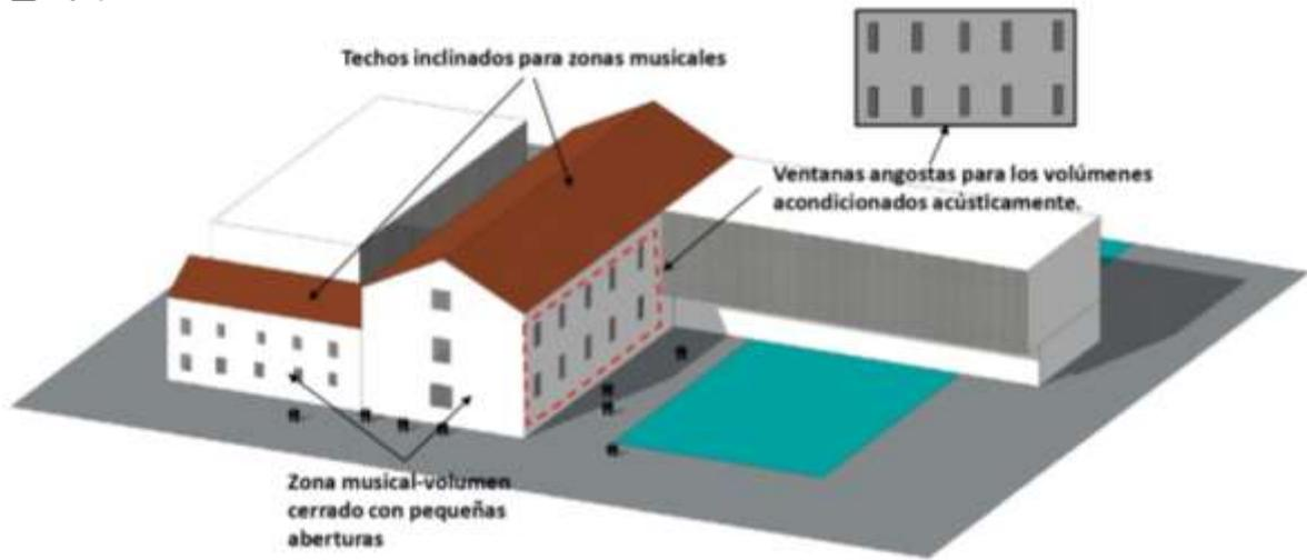
Figura 22. Vista isométrica (Fuente: Elaboración propia)
