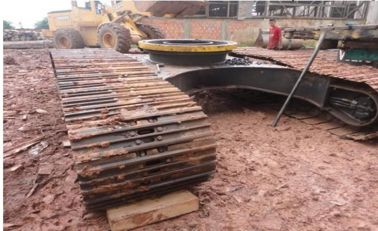
*Figura 25. Sistema de Estructura de excavadora marca Komatsu modelo PC350LC-8.*
