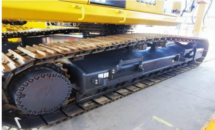
*Figura 23. Sistema Tren de Rodado de excavadora sobre orugas marca Komatsu modelo PC350LC-8.*
