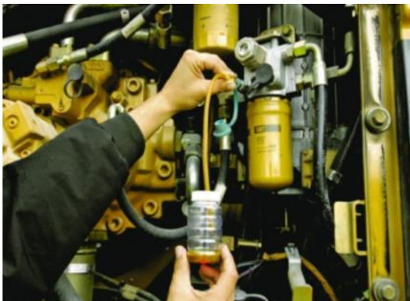
Figura 45. Muestreo de Aceite de motor PC350LC-8.
