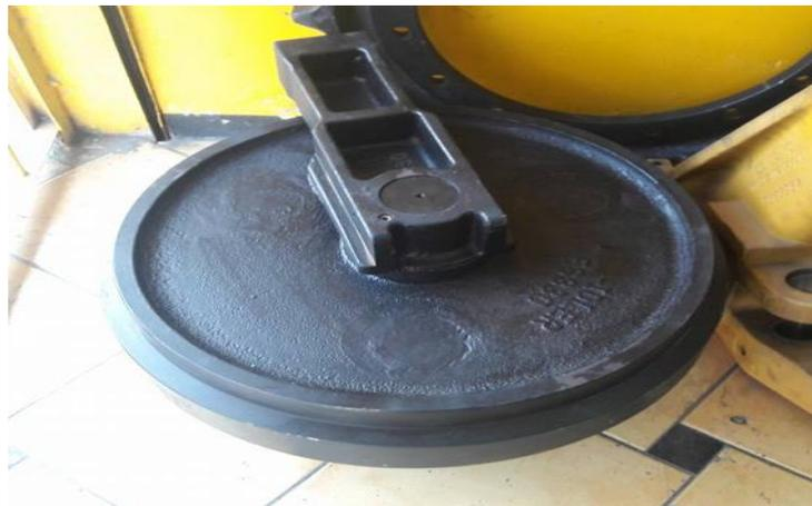
*Figura 24. Rueda Guía de excavadora sobre orugas modelo PC350LC-8*
