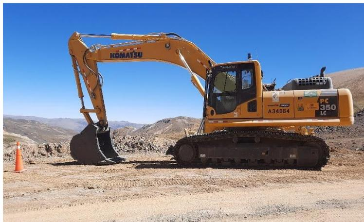
*Figura 15. Excavadora Hidráulica sobre orugas marca Komatsu modelo PC350LC-8*
