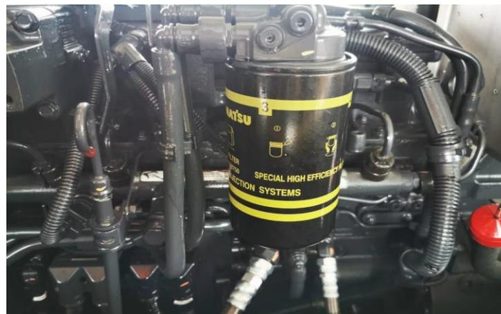
*Figura 17. Sistema de Combustible de excavadora sobre orugas modelo PC350LC-8.*
