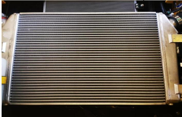
*Figura 19. Sistema de Admisión de excavadora sobre orugas marca Komatsu modelo PC350LC-8*
