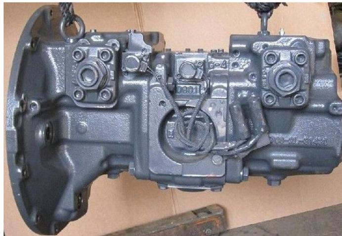
*Figura 21. Bomba Hidráulica de excavadora sobre orugas marca Komatsu modelo PC350LC-8.*
