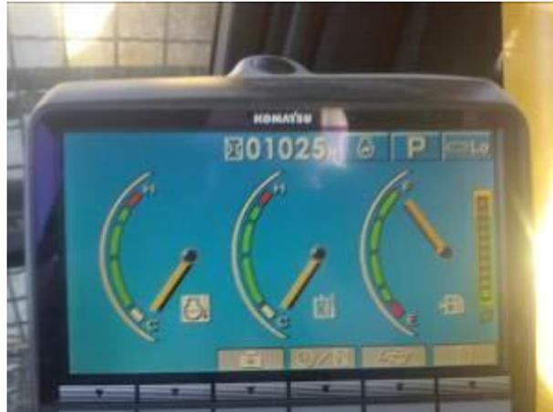
*Figura 22. Panel Monitor de Excavadora sobre orugas marca Komatsu modelo PC350LC-8*
