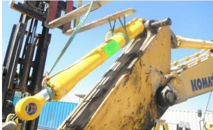
*Figura 20. Cilindro Hidráulico de excavadora sobre orugas marca Komatsu modelo PC350LC-8.*
