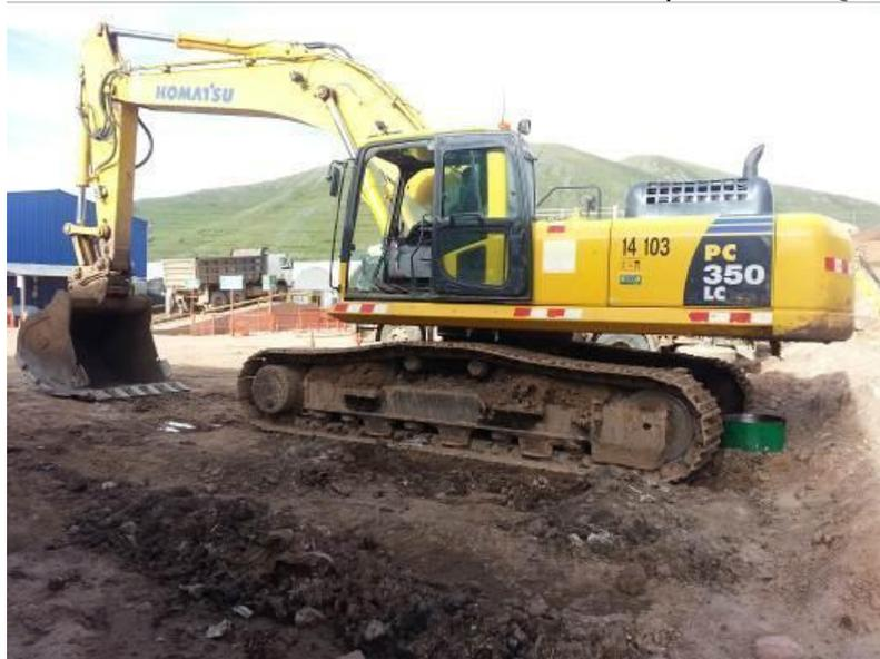
Figura 26. Excavadora sobre orugas marca Komatsu modelo PC350LC-8.
