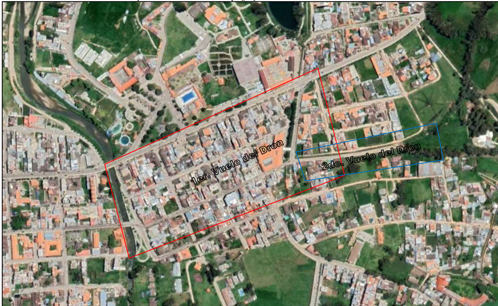
Figura 7 Distribución de los vuelos del dron para el levantamiento topográfico
