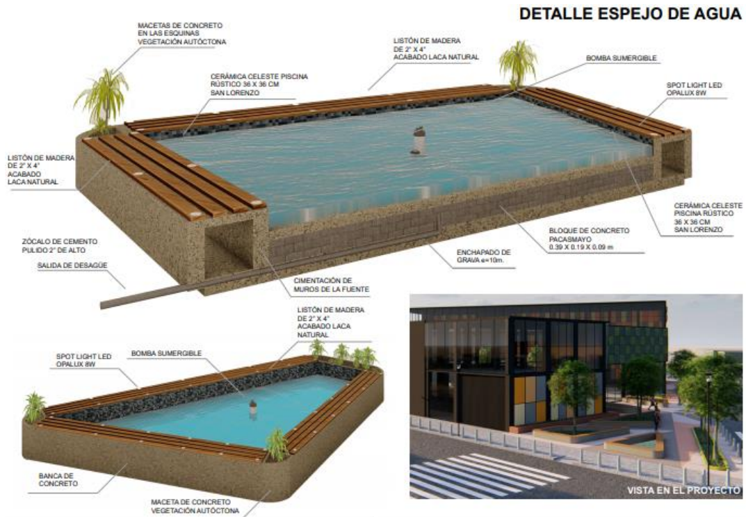
Figura N° 61. Lamina de detalles
