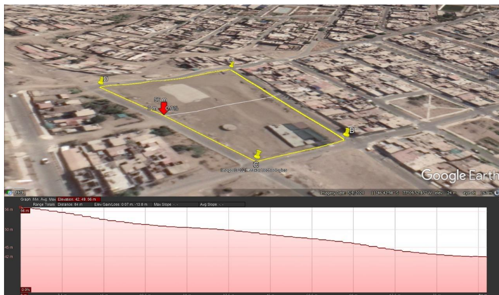
Figura N° 38. Corte Topográfico de terreno N.º 1
