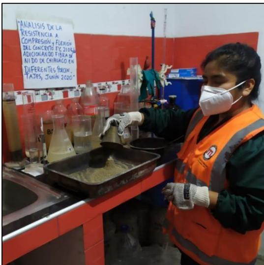
7. Finalmente se introduce en el horno durante 24 horas, luego lo pesaremos y así obtener el porcentaje de absorción del agregado fino.
