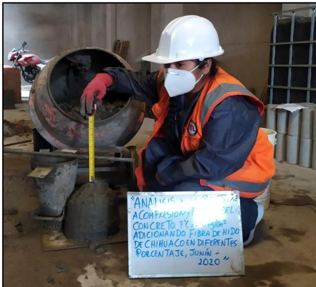
*Nota En la figura apreciamos que el slam con 0.2% de adición de fibra es de 4.5''*
