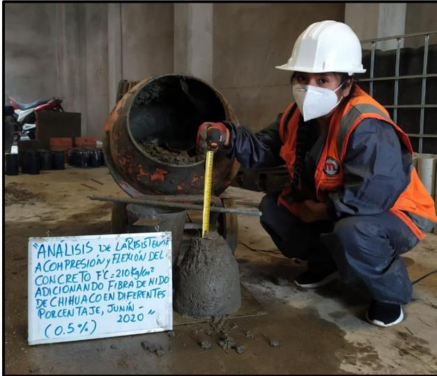
*Nota* En la figura apreciamos que el slam con 0.5% de adición de fibra es de 4”
