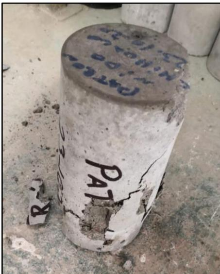
**Cálculo de resistencia a la compresión:** La resistencia a la compresión de la probeta se
