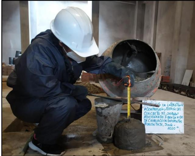
*Nota En la figura apreciamos que el slam con 0.0% de adición de fibra es de 5''*
