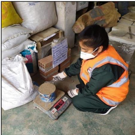
5. Realizamos el mismo procedimiento con el agregado grueso para obtener el promedio del peso unitario Suelto de la muestra.
