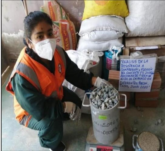
***Procedimiento de peso unitario compactado del agregado fino y grueso:*** El proceso se detalla a continuación:
