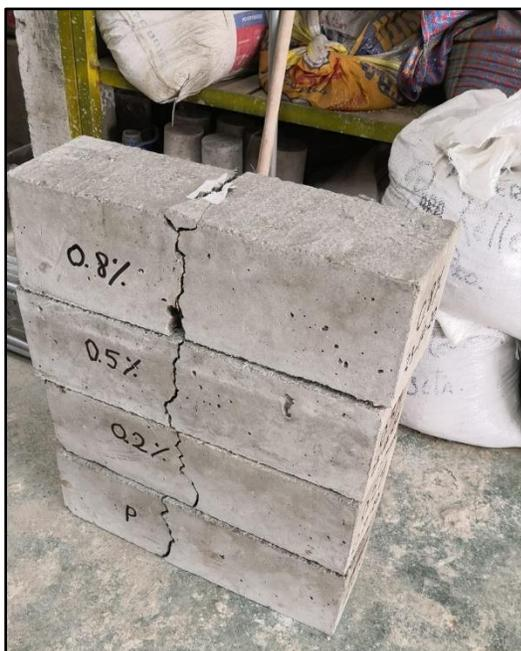
**Cálculo de la resistencia Flexión:** Para esta etapa se realizará el cálculo de la resistencia a flexión en la maquina universal de ensayos, el cual consiste en apoyar las vigas a 2.5 cm como mínimo de sus extremos, con una luz de 45 cm y colocarlos en dos puntos situados en los tercios medios de la luz. Cabe mencionar que el esfuerzo máximo de flexión se le llamará módulo de rotura, y se produce cuando la falla ocurra dentro del tercio medio de la luz libre de la viga (Sanchez,2001).
