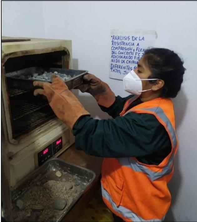
3. Procedemos a retirar el agregado grueso del horno y después de un tiempo prudente lo pesamos y tomamos nota del peso.
