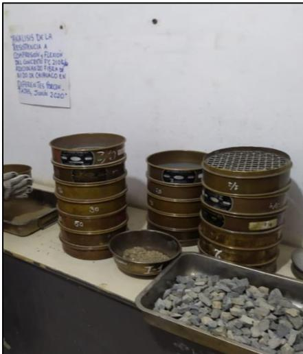
Los resultados del análisis granulométrico que se muestra a continuación pertenecen al agregado grueso, proveniente de la cantera del Río Chanchamayo.
