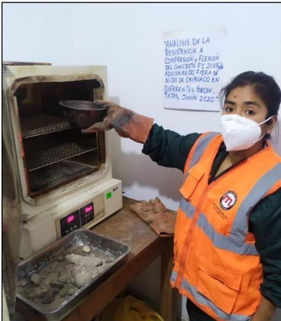
2. Retiramos la muestra del horno y la cubrimos con agua durante 24 horas, seguidamente extendemos la muestra sobre una superficie adecuada expuesta a una corriente suave tibia de ventilación y la removemos hasta que adquiera un secado uniforme y que los granos no se adhieran entre sí.
