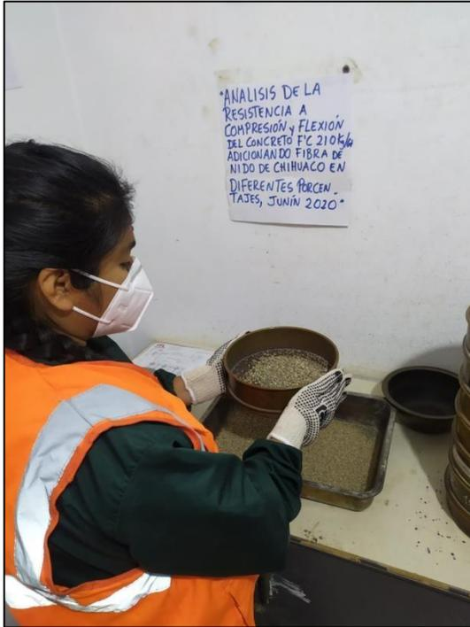
Los resultados del análisis granulométrico que se muestra a continuación pertenecen al agregado fino, proveniente de la cantera del Río Chanchamayo.
