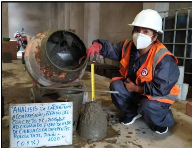
*Nota* En la figura apreciamos que el slam con 0.8% de adición de fibra es de 3.5”
