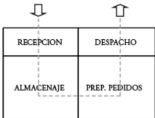
Figura 7. Distribución de Almacén en forma de U.
