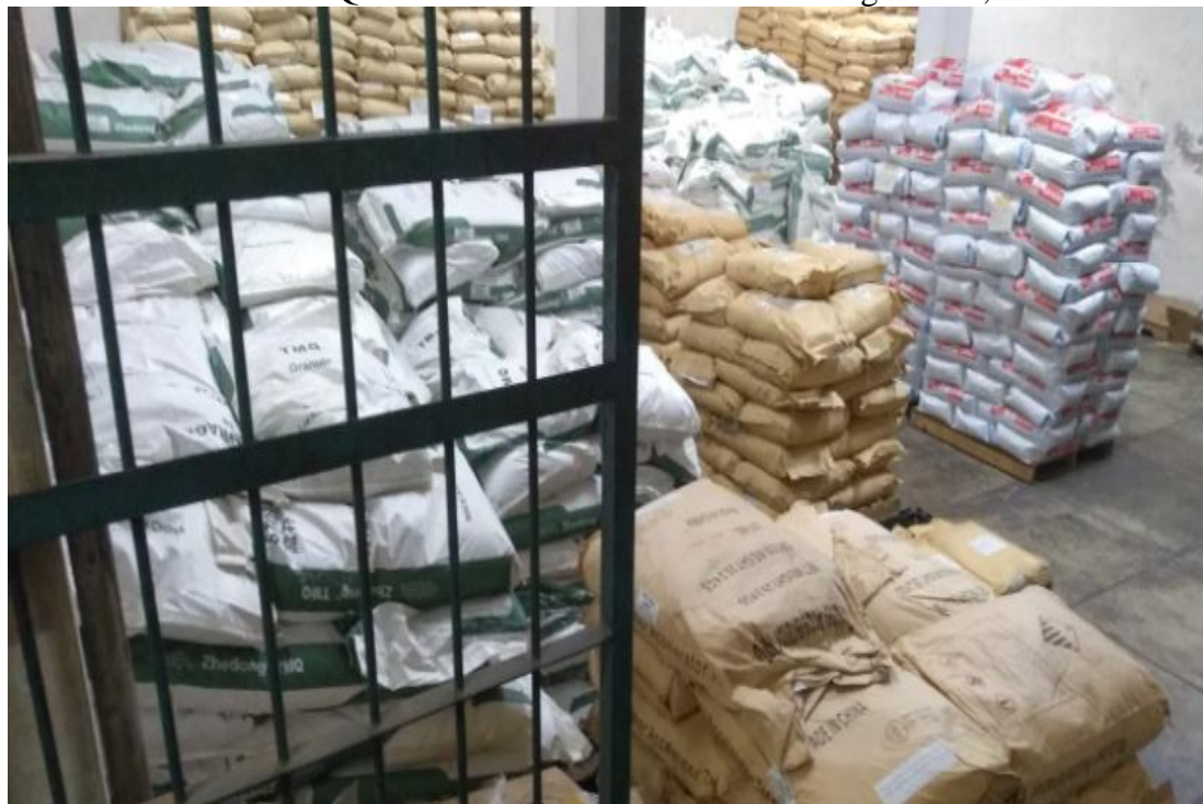
Figura 31. Productos químicos almacenados sin ubicaciones sin compatibilidad (Toma III) en el Almacén de Productos Químicos de AG International Trading S.A.C., 2019.
