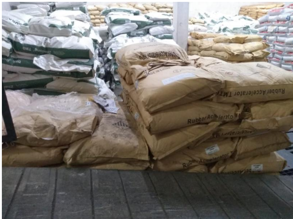
Figura 27. Productos químicos almacenados sin rotulación y sobre el suelo (Toma III) en el Almacén de Productos Químicos de AG International Trading S.A.C., 2019.
