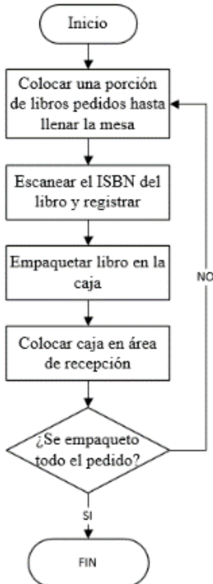
Figura 46: Flujograma del Proceso de Empaquetado
