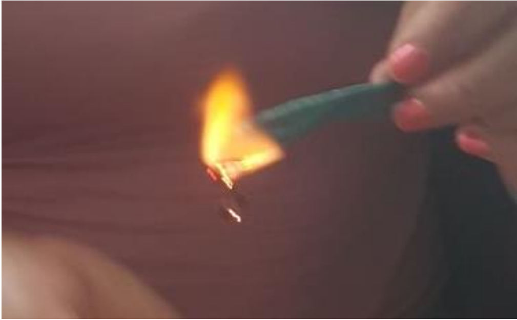
Figura 12. Inflamabilidad del bioplástico
