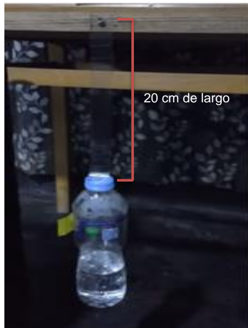
Figura 13. Medida de resistencia a la tensión (cm/mL) haciendo uso de una botella plástica
