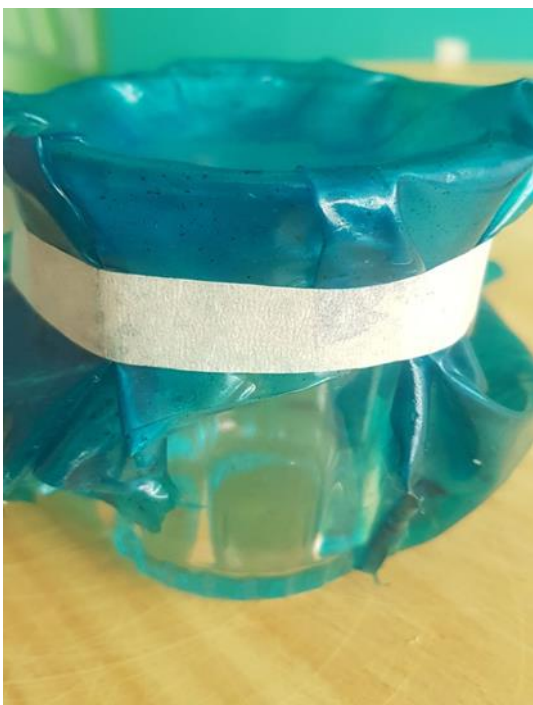
Figura 8. Prueba de permeabilidad ( mL*s*Kg*Pa*m ) utilizando agua de potable
