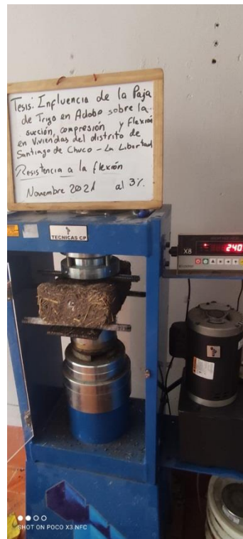
Anexo 49: Ensayo a la flexión de unidades de adobe con adición de paja del 3%
