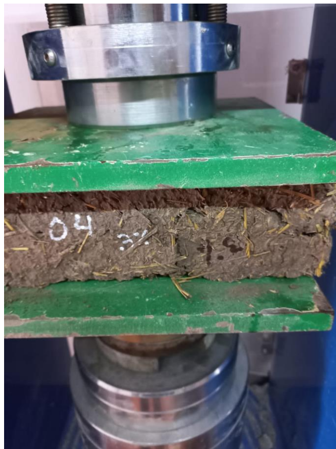
Anexo 35: Ensayo a la compresión de unidades de adobe con adición de paja del 3%
