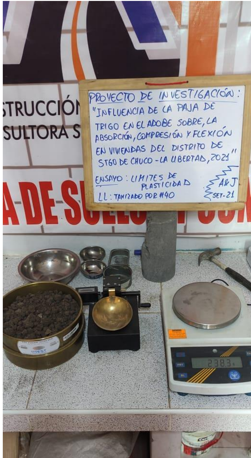
Anexo 8: Limite Líquido, tamizado por Tamiz N°40
