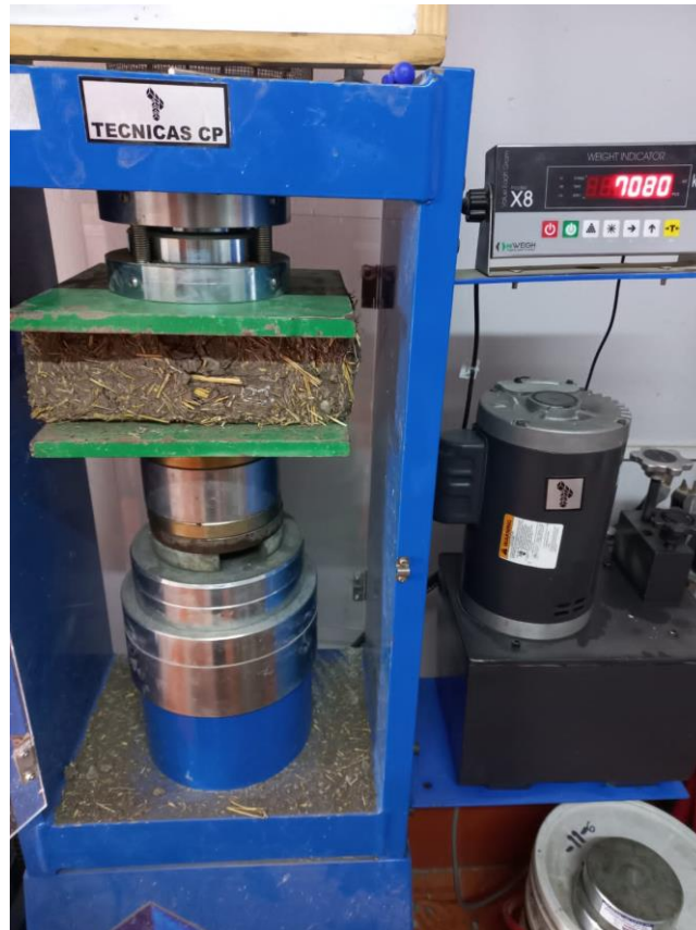
Anexo 38: Ensayo a la compresión de unidades de adobe con adición de paja del 5%
