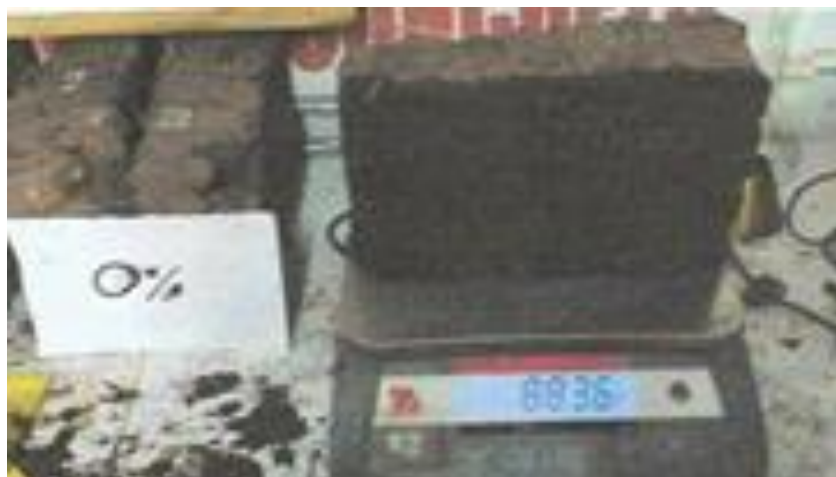
Anexo 56: Ensayo a succión de unidades de adobe con adición de paja del 0%
