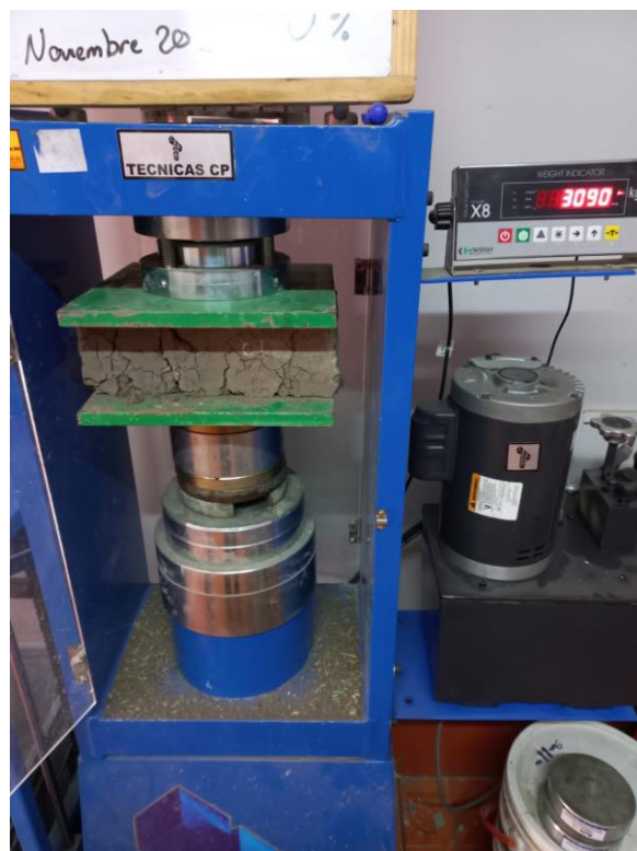
Anexo 25: Ensayo a la compresión de unidades de adobe con adición de paja del 0%
