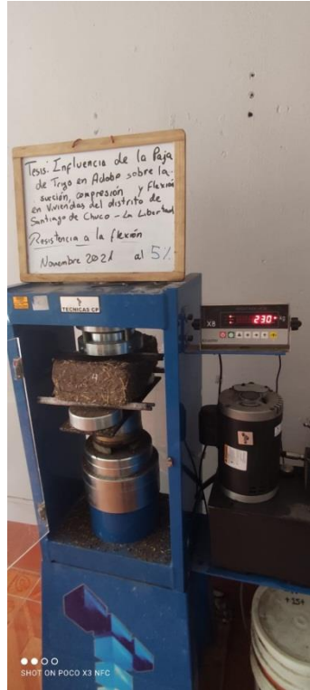
Anexo 52: Ensayo a la flexión de unidades de adobe con adición de paja del 5%
