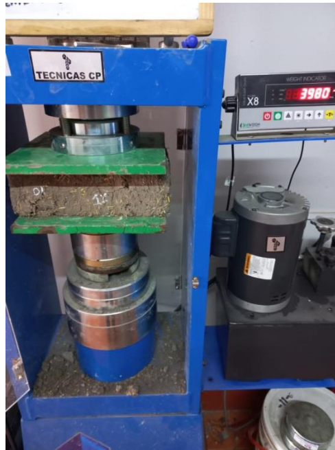
Anexo 30: Ensayo a la compresión de unidades de adobe con adición de paja del 1%
