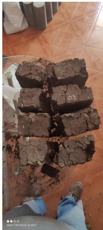
Anexo 41: Ensayo a la flexión de unidades de adobe con adición de paja del 0%
