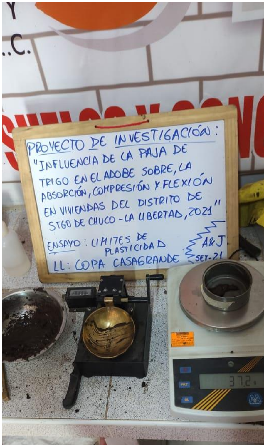
Anexo 10: Ensayo de la copa de Casagrande
