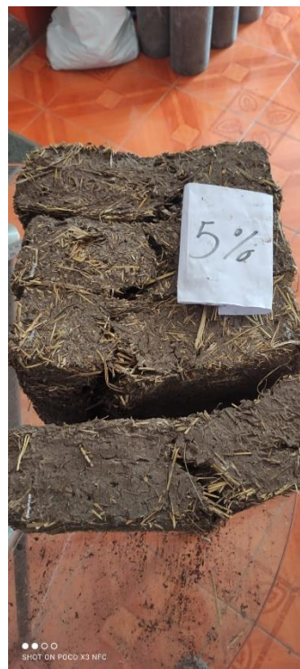
Anexo 51: Familia de adobes ensayados a flexión con adición de paja de trigo del 5%
