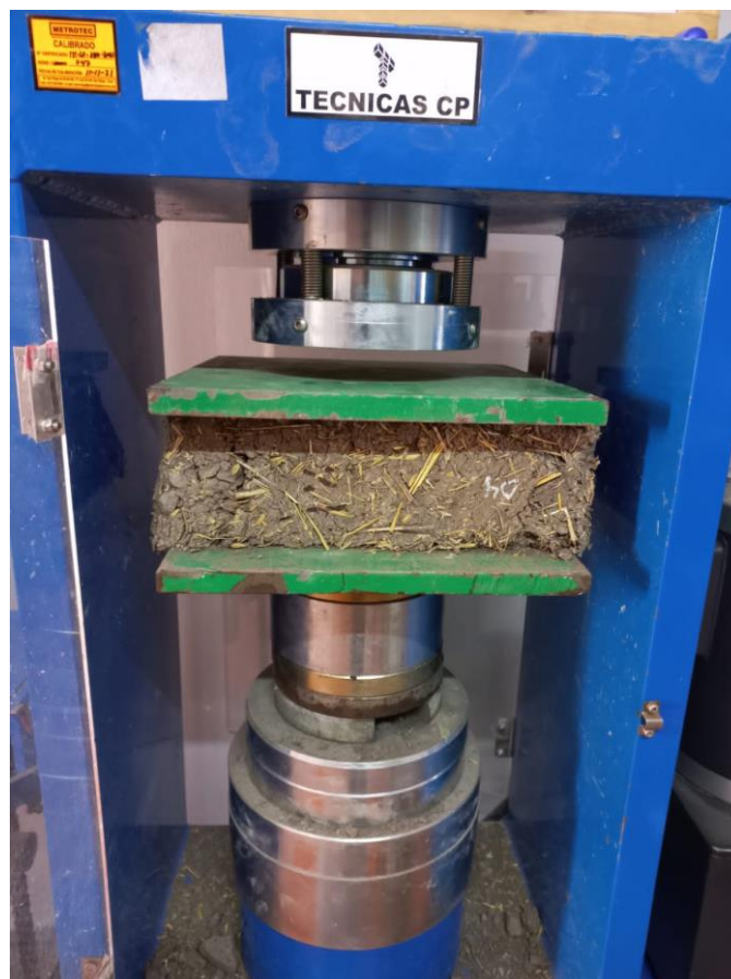
Anexo 39: Ensayo a la compresión de unidades de adobe con adición de paja del 5%
