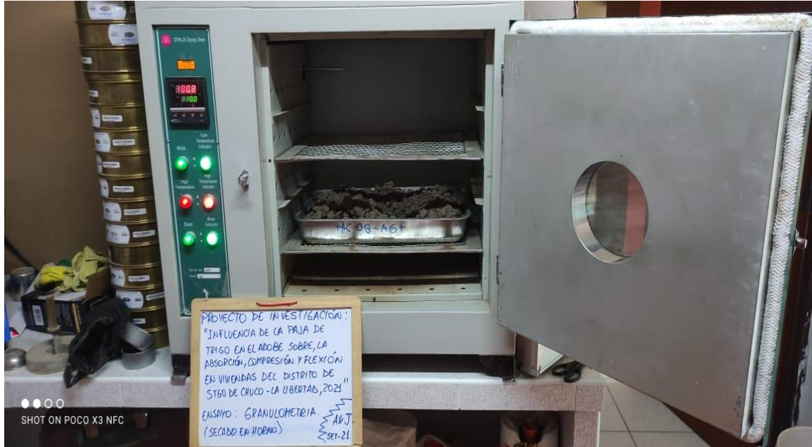
Anexo 3: Ensayo de Granulometría, material secado al Horno
