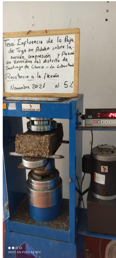
Anexo 50: Ensayo a la flexión de unidades de adobe con adición de paja del 5%
