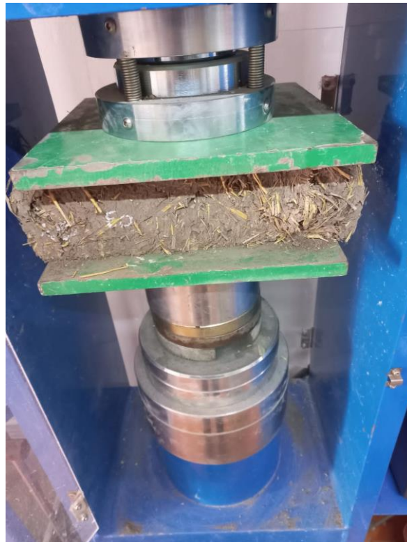
Anexo 37: Ensayo a la compresión de unidades de adobe con adición de paja del 5%
