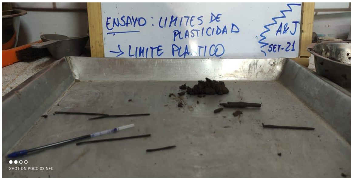
Anexo 6: Ensayo de Limite Plástico
