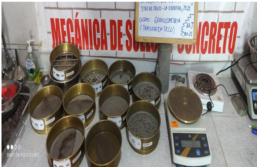
Anexo 4: Ensayo de Granulometría, Tamizado en Seco
