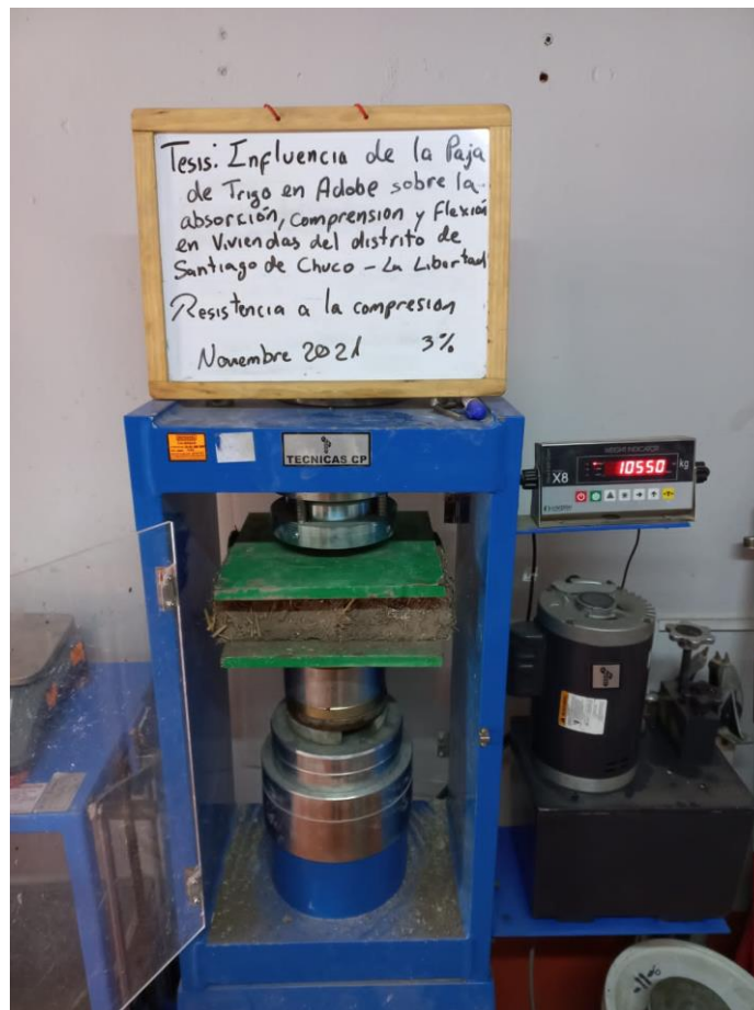
Anexo 33: Ensayo a la compresión de unidades de adobe con adición de paja del 3%
