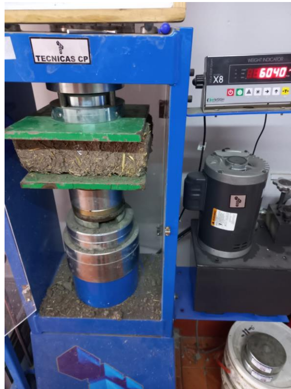
Anexo 34: Ensayo a la compresión de unidades de adobe con adición de paja del 3%
