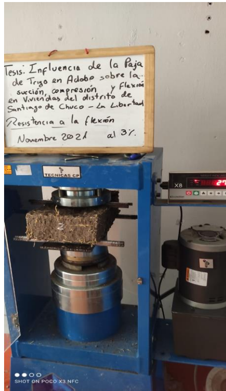
Anexo 48 : Ensayo a la flexión de unidades de adobe con adición de paja del 3%
