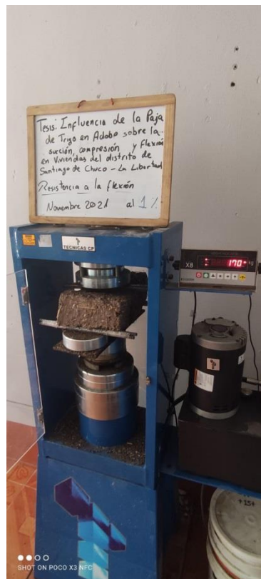
Anexo 45: Ensayo a la flexión de unidades de adobe con adición de paja del 1%
