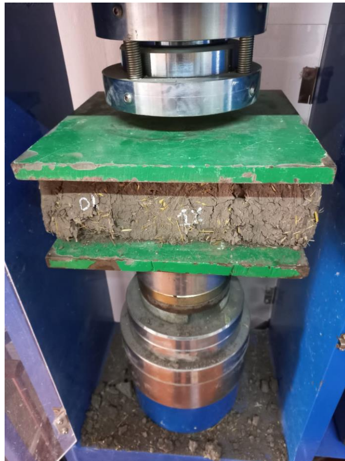
Anexo 31: Ensayo a la compresión de unidades de adobe con adición de paja del 1%
