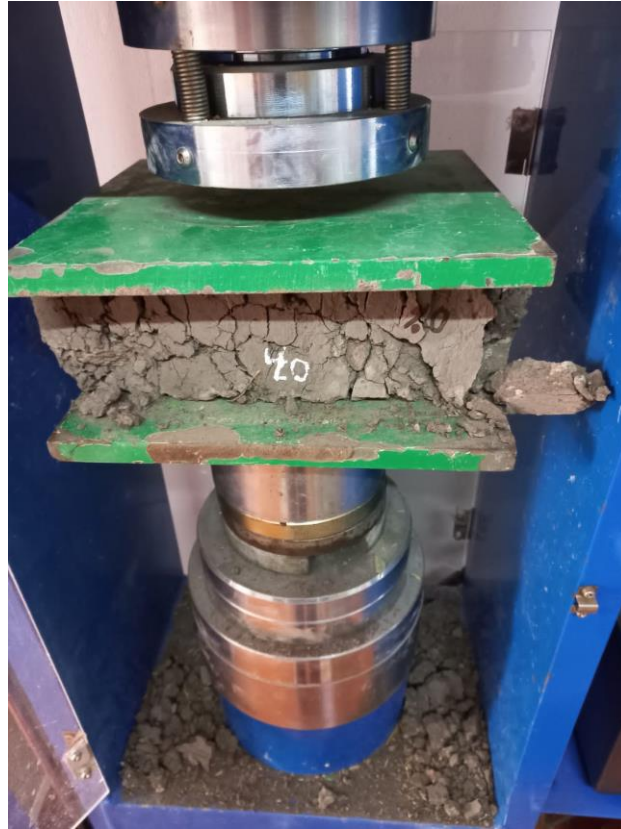
Anexo 26: Ensayo a la compresión de unidades de adobe con adición de paja del 0%
