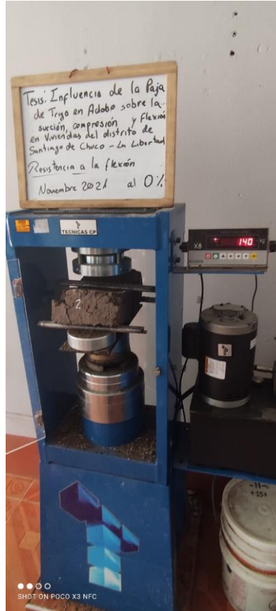
Anexo 42: Ensayo a la flexión de unidades de adobe con adición de paja del 0%
