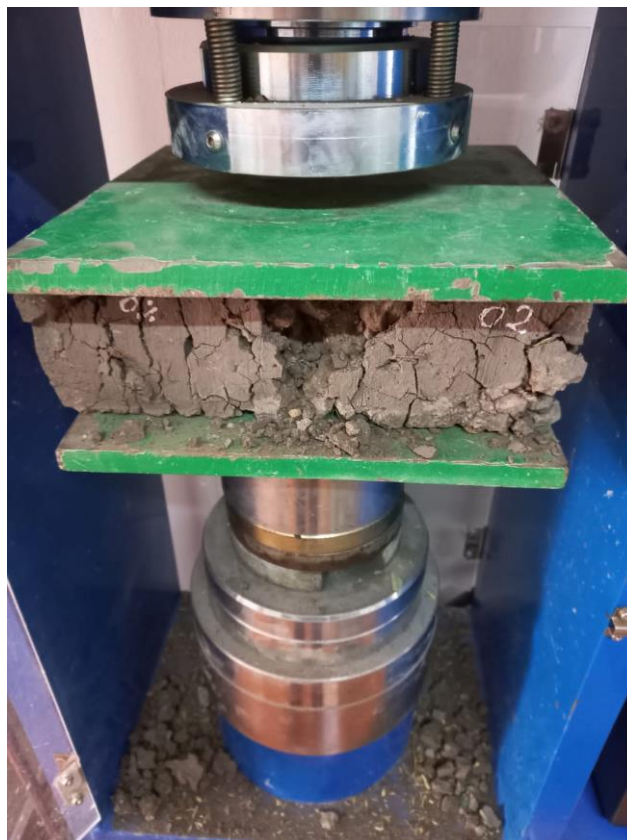
Anexo 27: Ensayo a la compresión de unidades de adobe con adición de paja del 0%
