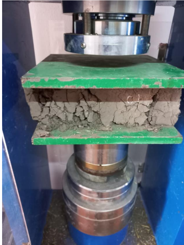
Anexo 24: Ensayo a la compresión de unidades de adobe con adición de paja del 0%
