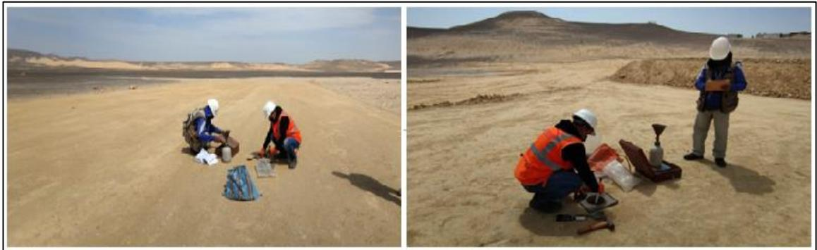
Figura 18. Ensayos de densidad de campo en plataformas
