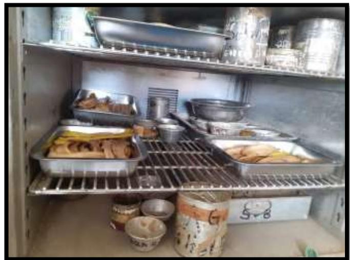
Nota: En este proceso, las cáscaras de plátano, previamente pesadas y colocadas en bandejas de aluminio; se introducen dentro de la estufa, por un período de 2 días y a una temperatura de  $65^{\circ}\text{C} \pm 0.5^{\circ}\text{C}$ .
