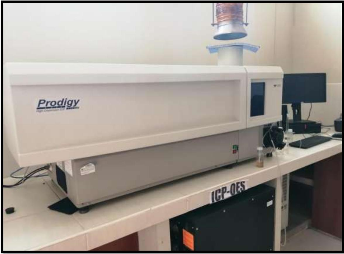
Nota: En esta imagen se muestra en donde se realizaron los análisis se llevan a cabo por Espectrofotometría de Emisión, utilizando un Plasma Acoplado por Inducción, Varian, modelo PRODIGY.
