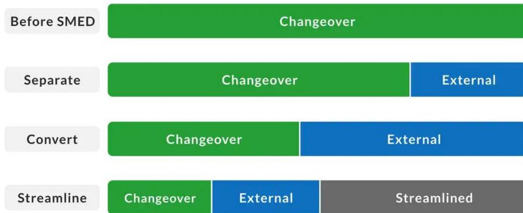
**Figura n.º 7.** Fases del sistema SMED y su impacto en la reducción del tiempo de cambio
