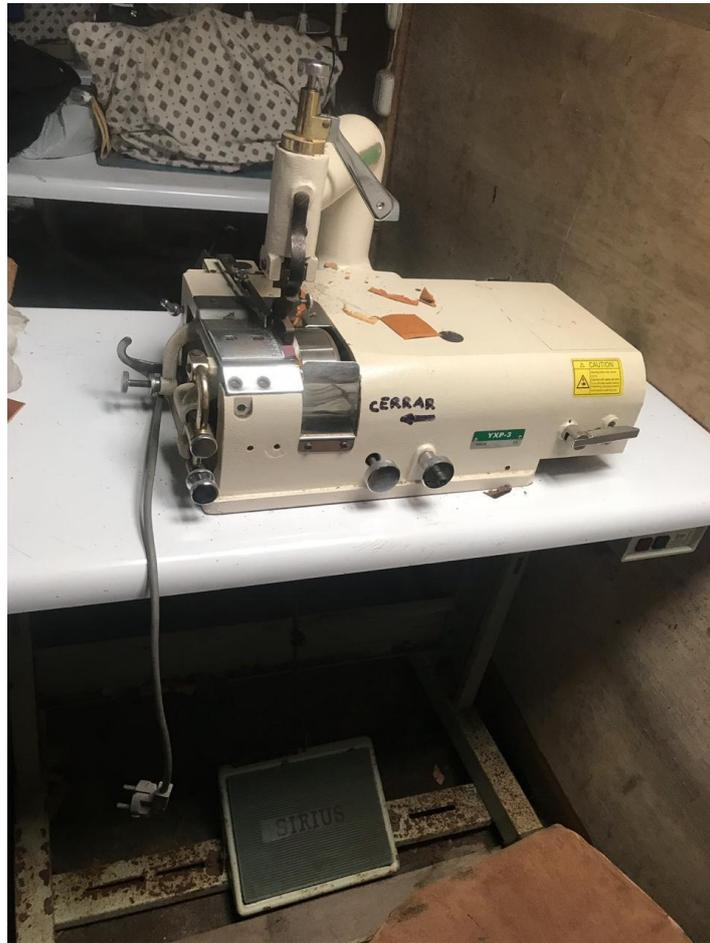
**Figura n.º 32..**Identificación no apropiada en máquina confeccionadora
