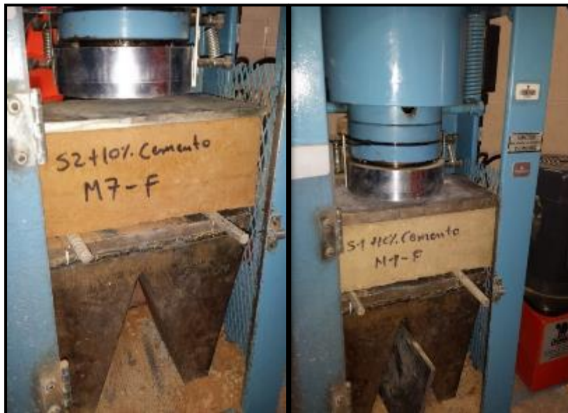
Fotografía N° 25. Ensayo a flexión de las muestras.
