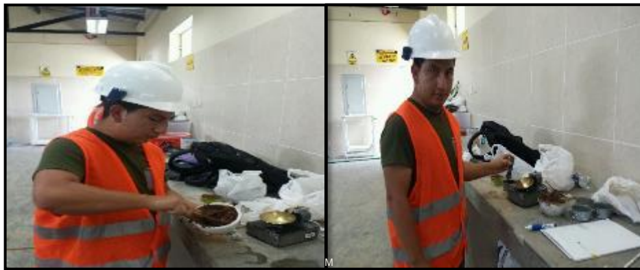
Fotografía N° 3. Ensayo de limite liquido de los suelos S1 y S2.
