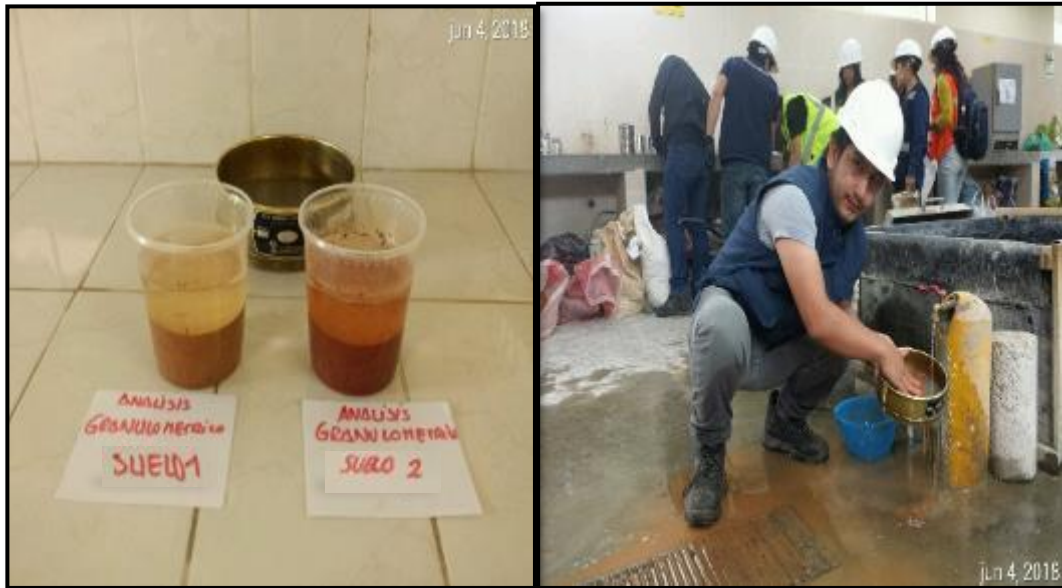
Fotografía N° 6. Ensayo granulométrico en tamizado por lavado de los suelos s1 y s2.
