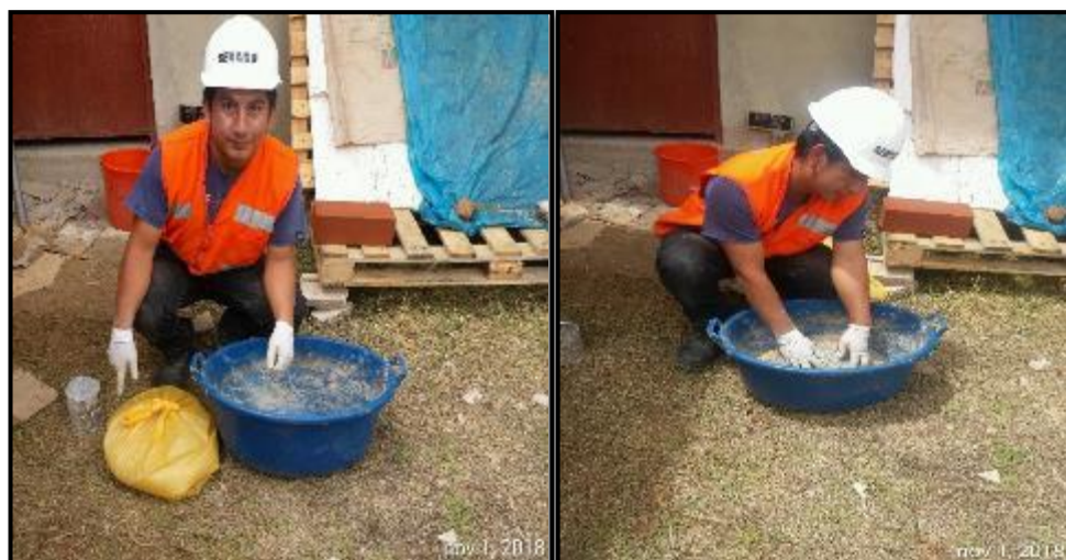
Fotografía N° 11. Mezclado de muestras patrón y con adición de cemento.
