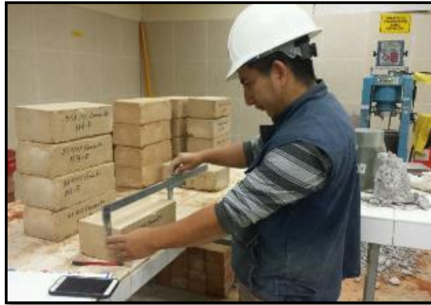
Fotografía N° 22. Toma de medidas de las muestras
