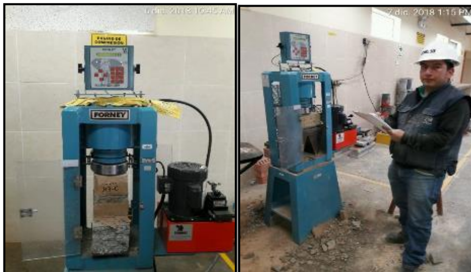
Fotografía N° 23. Ruptura de muestras en la maquina compresora.
