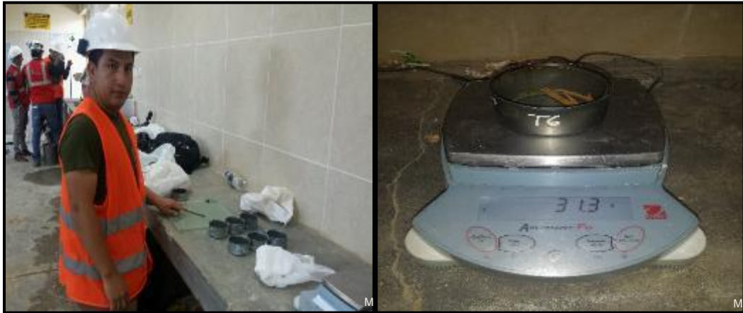
Fotografía N° 4. Ensayo de limite plástico de los suelos s1 y s2.
