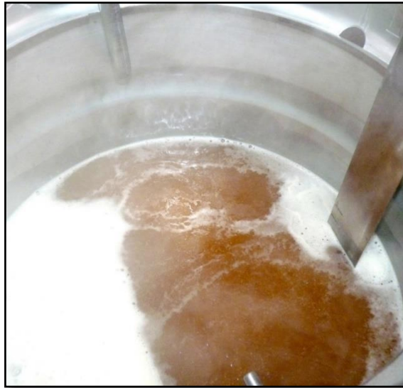
Figura 4: Pérdida de mosto por evaporación
