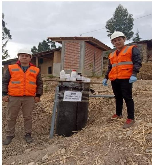
Nota: en la figura 8 se muestra los recipientes con las muestras tomadas de los prototipos para ser llevados al laboratorio.
