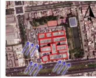
Los bloque que están ubicados en la parte frontal del instituto (Av. Javier Prado) logran obtener ventilación natural, sin embargo, por mas que se tenga un diseño escalonado como emplazamiento, no logra ventilar de la manera mas optima la parte posterior.
