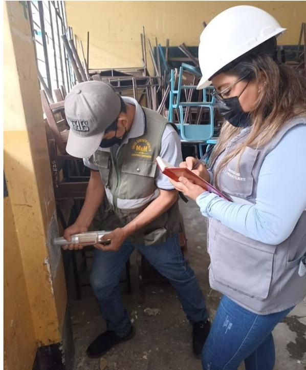
*Figura 11:* Procedimiento del ensayo esclerometría en campo
