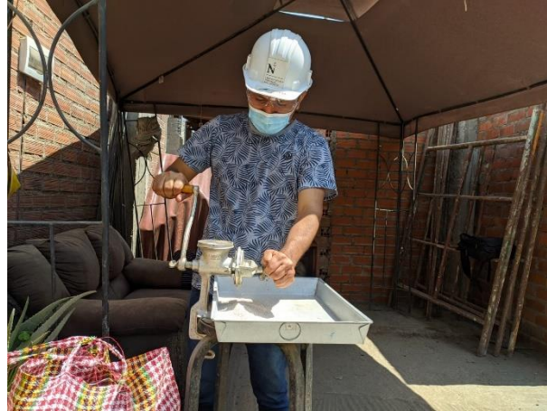
Ilustración 48. Cascara de huevo en etapa de pulverización
