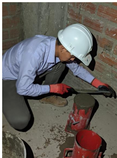
Ilustración 55. Nivelado de probeta para su posterior fraguado
