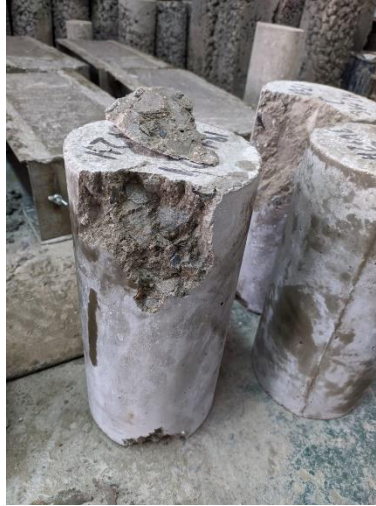
Ilustración 56. Fallo de probeta a compresión
