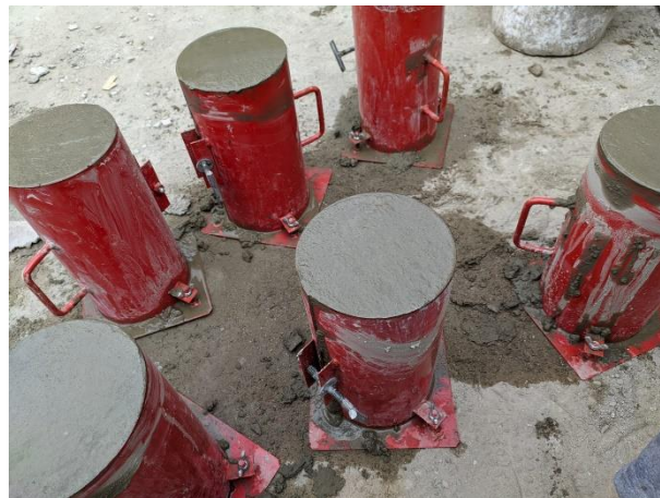
Ilustración 45. Fraguado de probetas
