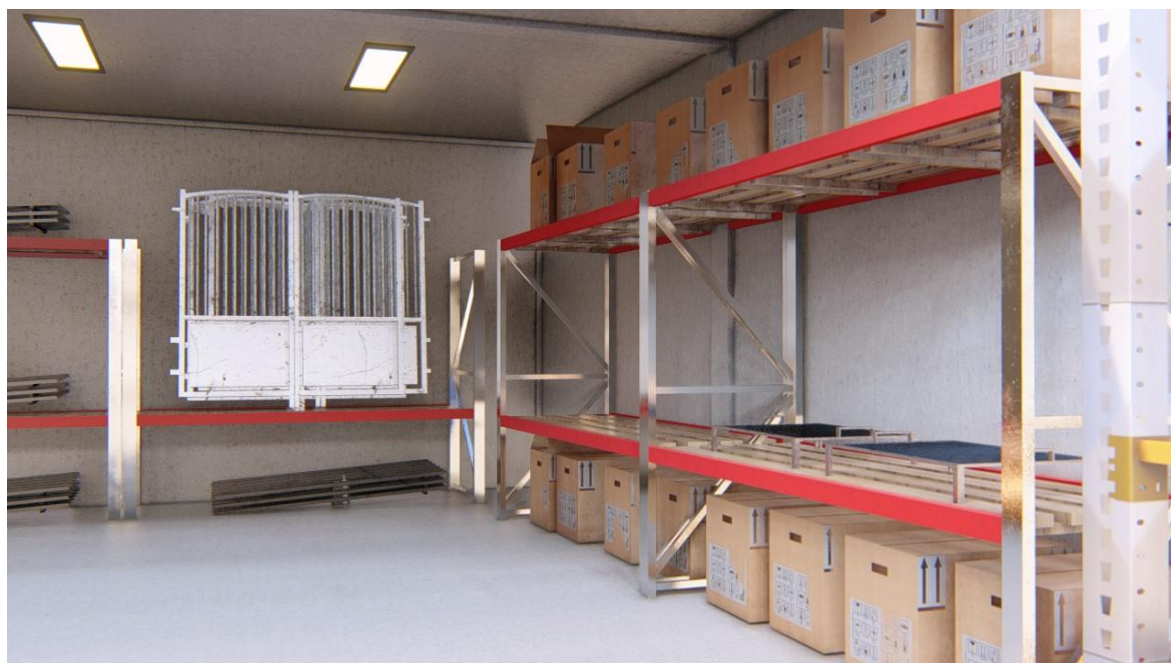
Figura 20. Esta visualización se ha renderizado en el programa Lumion 8, lográndose observar el mobiliario interno de media carga o Picking, teniendo una altura total de 3.60mts, donde cada módulo del mobiliario mide 2.40mts de largo y 1.20mts de ancho, en donde se almacenarán los portones y parrillas metálicas fabricadas por BAUR METALMIN.
