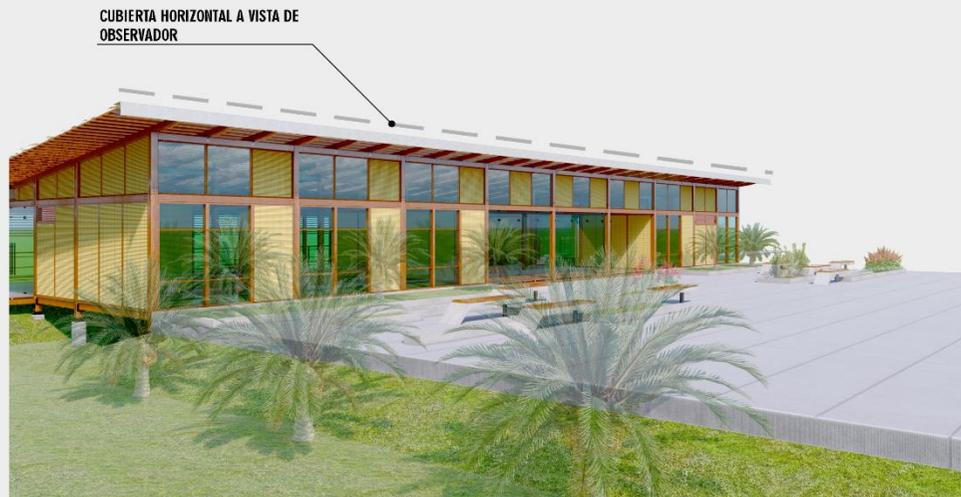
A través de la propuesta de una cubierta en “V”, invirtiendo el concepto típico que se tiene sobre el tipo de coberturas en zonas de la selva, se pretende conseguir coberturas horizontales desde el punto de observación del usuario.
