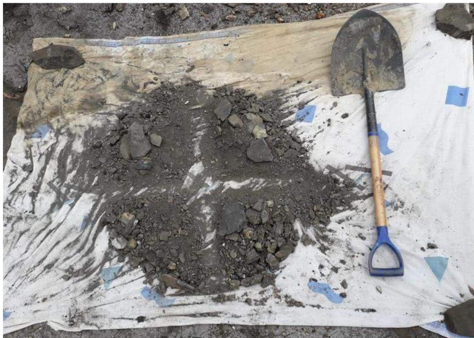
Figura 11 - Selección de la muestra por el método del cuarteo para laboratorio
