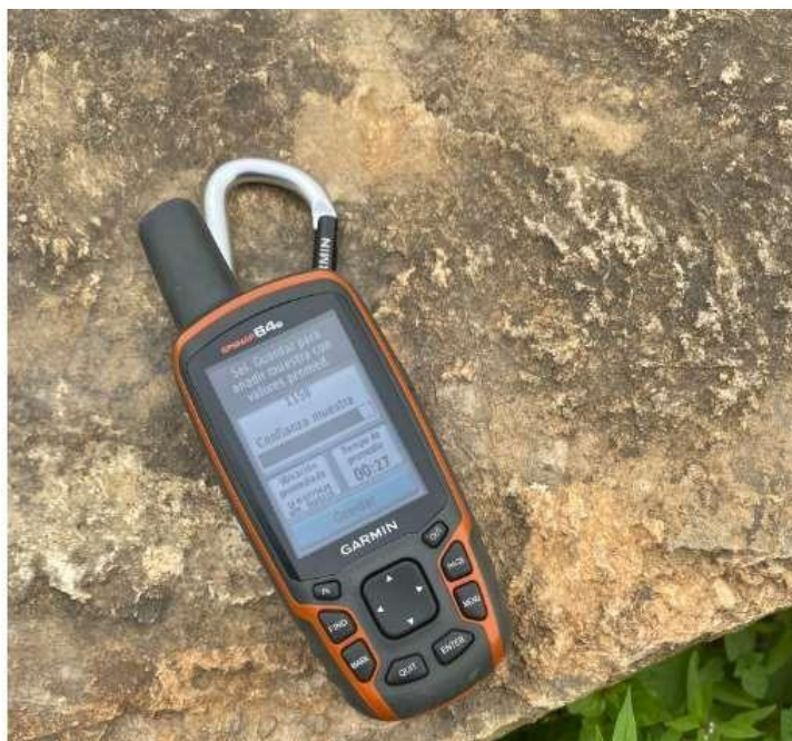
Fotografía N°12: Toma de punto de control para la estación total
