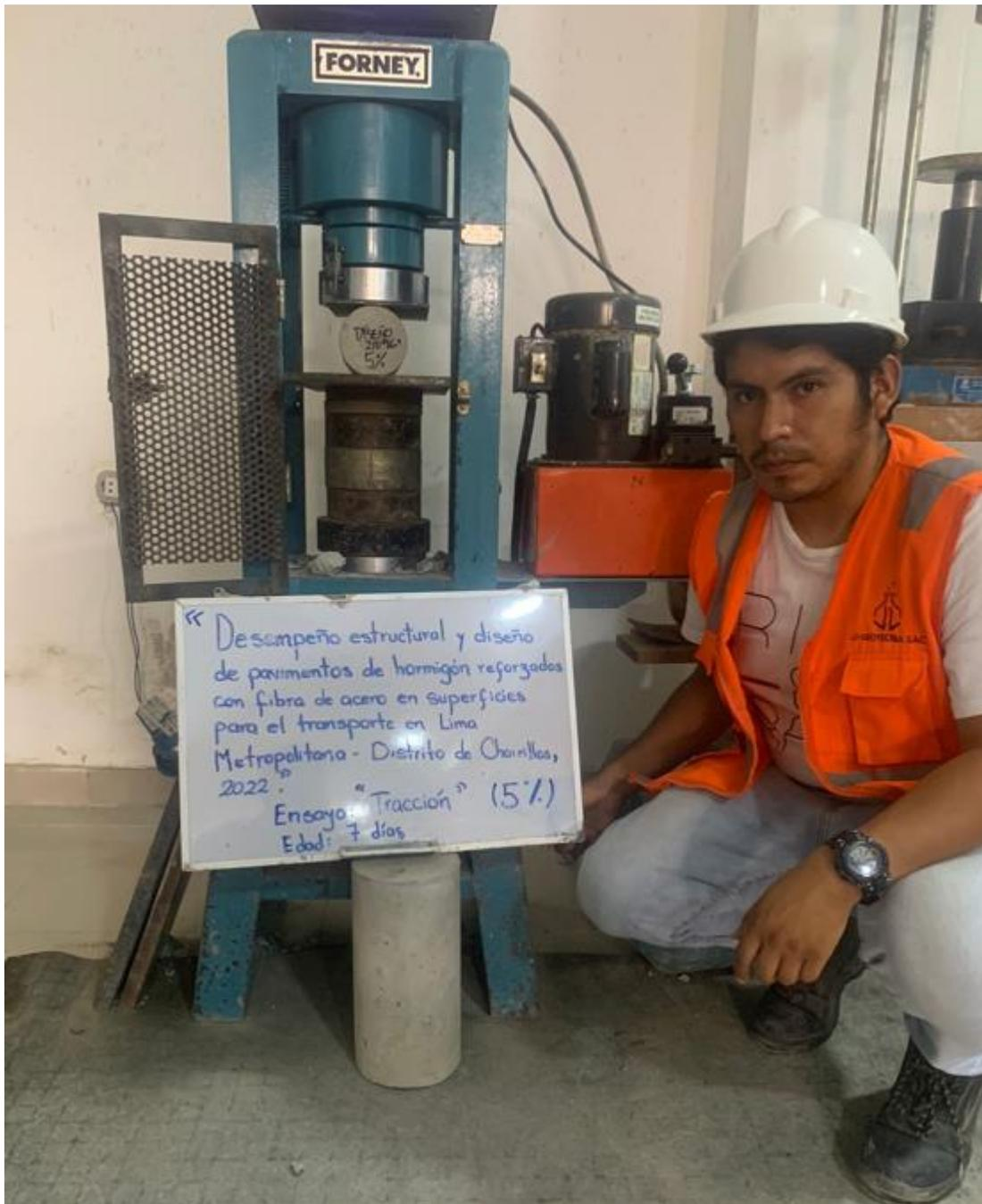
**Anexo 37: Análisis de tracción con agregado de fibra de Acero Dramix 8%**
