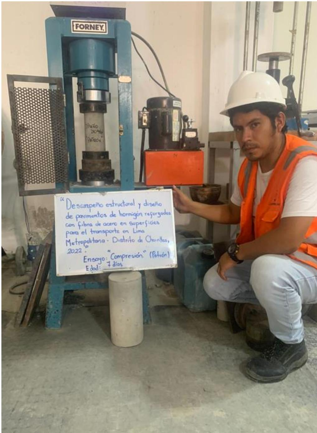
**Anexo 28:** Análisis de compresión con agregado de fibra de Acero Dramix 3%
