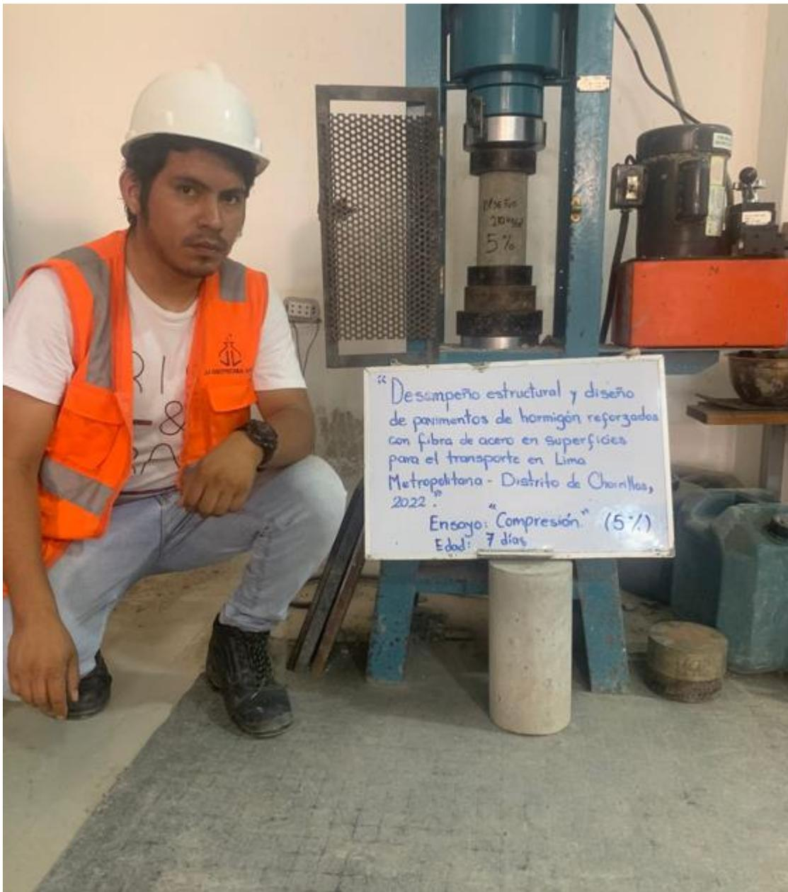
**Anexo 30:** Análisis de compresión con agregado de fibra de Acero Dramix 8%
