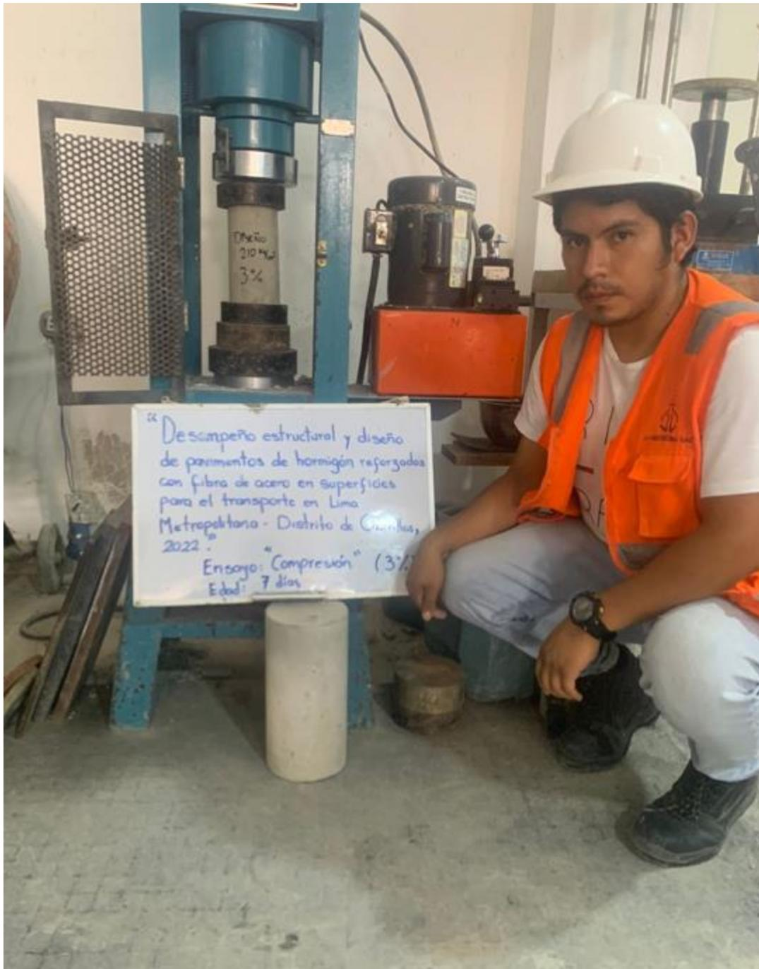
**Anexo 29:** Análisis de compresión con agregado de fibra de Acero Dramix 5%
