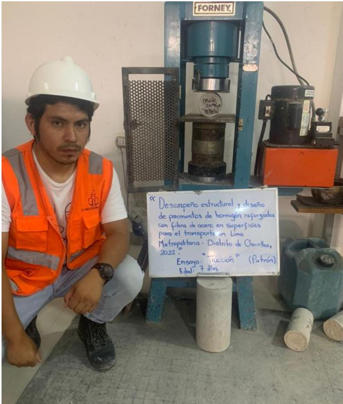
**Anexo 36: Análisis de tracción con agregado de fibra de Acero Dramix 3%**
