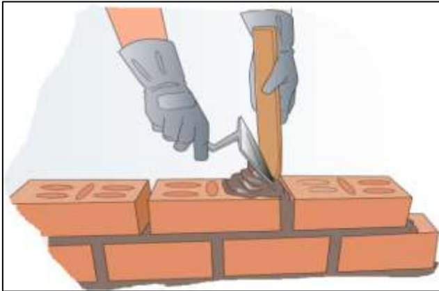
Figura 11 Colocación del mortero vertical.
