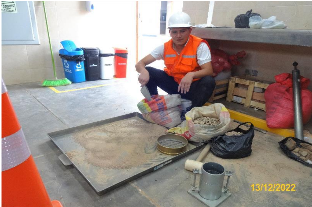
Nota: Realizando el tamizado del material por la malla N°4.
