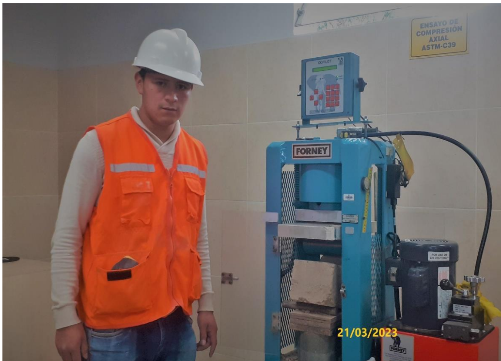
Nota: Realizando el ensayo de la resistencia a la flexión de los adobes.
