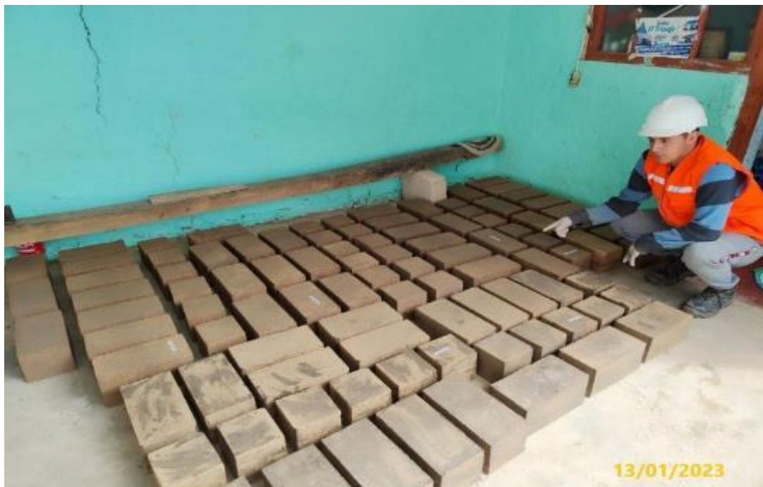
Nota: Realizando la inspección de los adobes.
