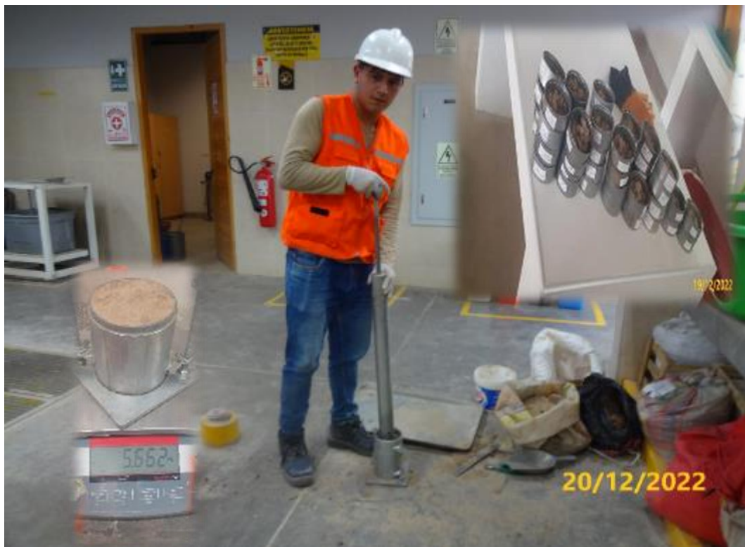
Nota: Realizando la compactación del proctor modificado con el martillo de compactación.
