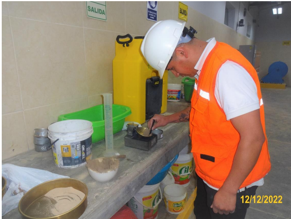
Nota: Realizando la Ranura con el Acanalador - Límite Líquido.
