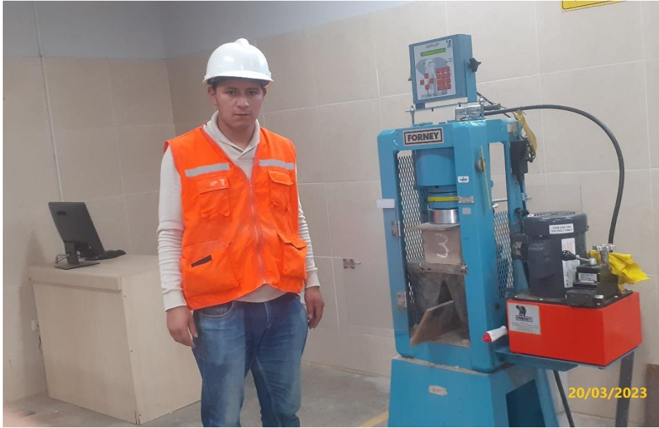
Nota: Realizando la resistencia a compresión de los adobes.
