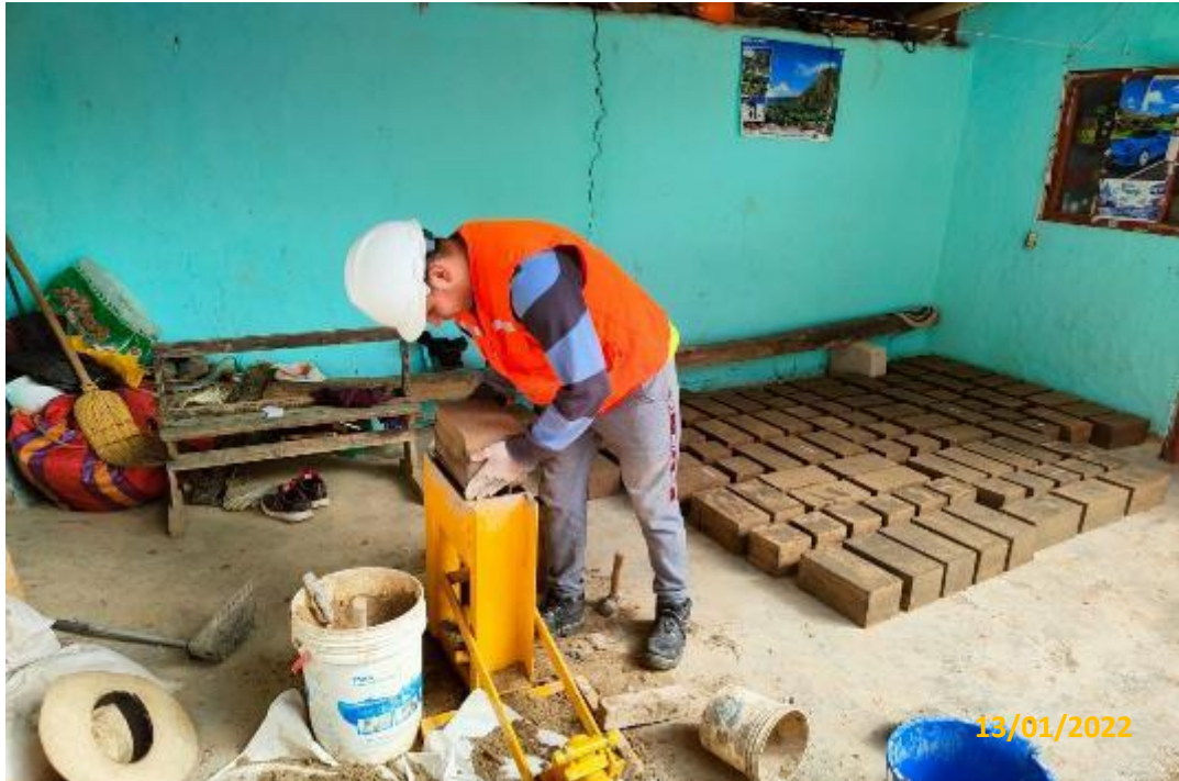
Nota: Adobe compactado con incorporación de 5% de penca y 50% barro fermentado.
