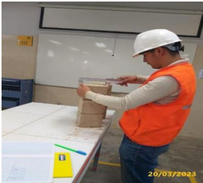
Nota: Realizando la medición de los adobes
