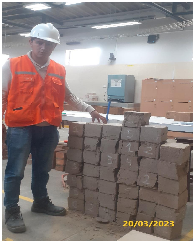
Nota: Culminación de los adobes ensayados a compresión.
