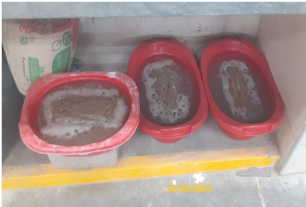
Nota: Los adobes compactados con los diferentes porcentajes de barro fermentado más la incorporación de polímeros naturales de tuna y de penca, no pasaron la prueba de absorción de agua. Pasado 8 a 12 horas los adobes compactados se desintegran.
