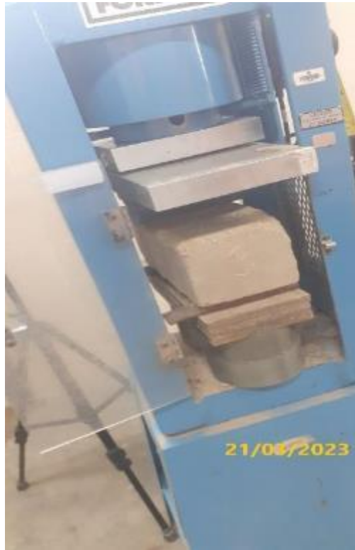
Nota: Iniciando Ensayo a Flexión de los Adobes.
