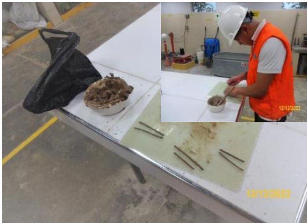
Nota: Realizando los rollitos de 3mm de diámetro – Límite Plástico.
