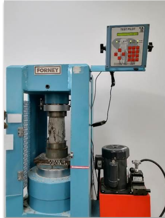
19. Ensayo de Resistencia a la compresión.
