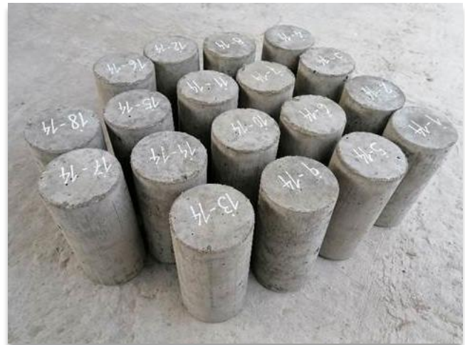
12. Probetas de concreto con agua potable – 14 días.
