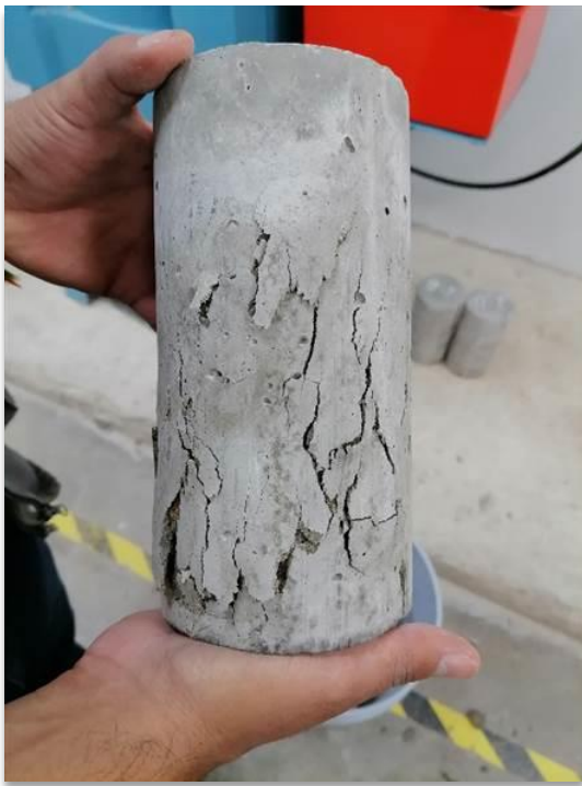
20. Rotura de probetas (Vista 1).
