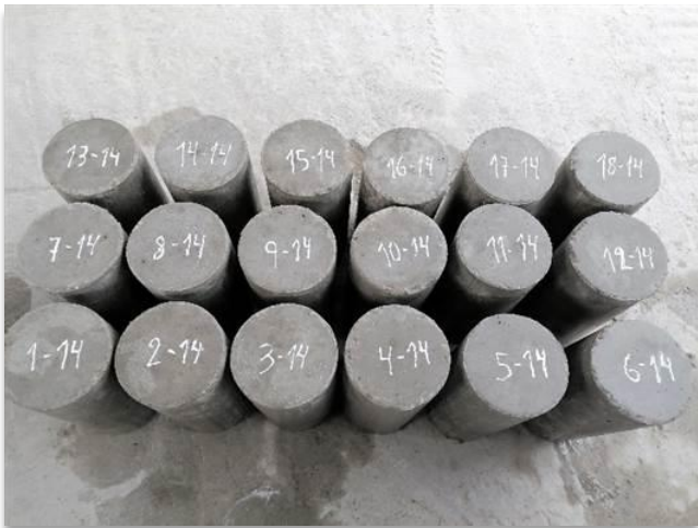
11. Probetas de concreto con agua no tratada – 14 días.
