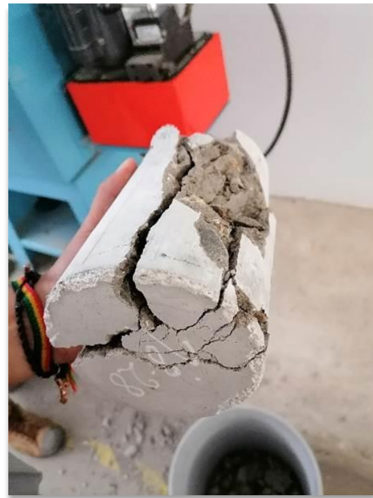
21. Rotura de probetas (Vista 2).
