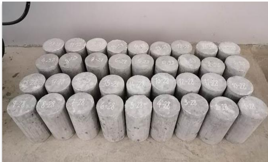
13. Probetas de concreto con agua no tratada y potable – 28 días.
