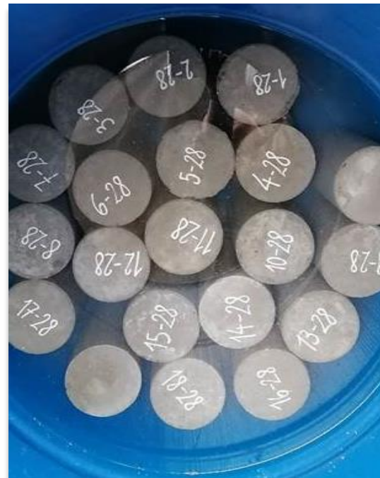
17. Curado de probetas a 28 días.
