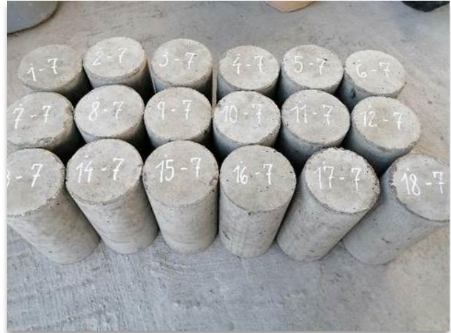
10. Probetas de concreto con agua potable – 7 días.
