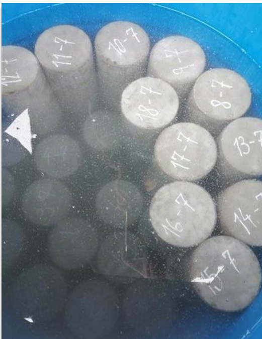
16. Curado de probetas a 7 días.
