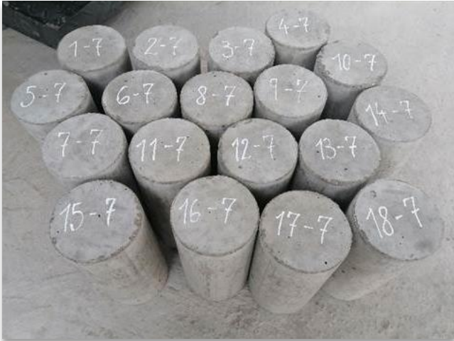
9. Probetas de concreto con agua no tratada – 7 días.
