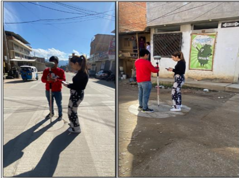
Figura 52. Levantamiento Topográfico de la zona en estudio mediante GPS Diferencial por el método de Medición Cinemática.
