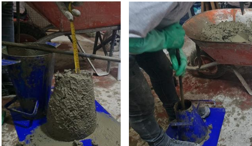
Slump del concreto.
