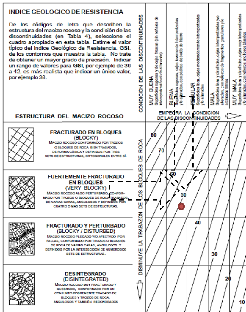
Figura16. Ploteo del Valor de GSI, en función de las estructuras y condiciones de las discontinuidades; en el cual se aprecia que el valor de GSI es 55
