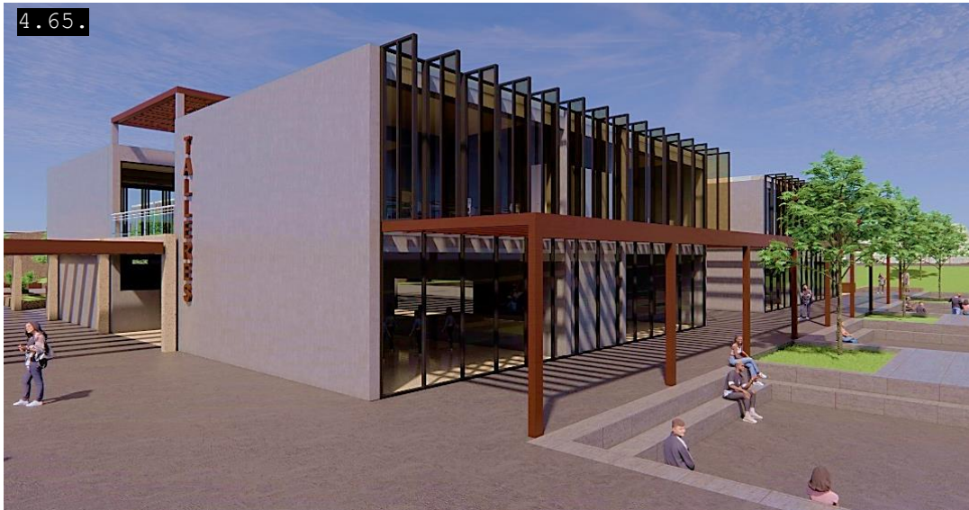
Figura 4.65. Vista: Bloque “A” - Educativo. Fachada abierta, donde se aprecian los parasoles que protegen los ambientes de la incidencia solar media. Fachada cerrada, para evitar la incidencia solar más fuerte. Edición: Elaboración propia.
