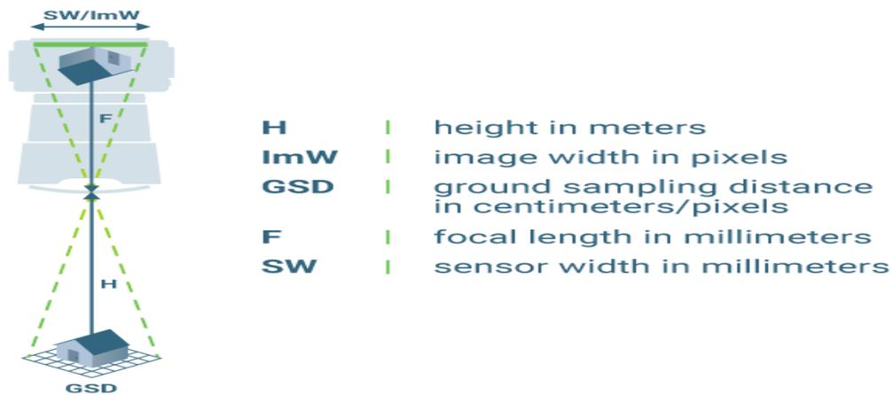
*Nota.* En esta figura se muestra el parámetro de cálculo de la altura de vuelo correcta, que implica la relación entre el ancho del sensor, la distancia focal y el ancho de la imagen. Adaptado de, ¿Qué es la precisión en un proyecto de mapeo aéreo?, PIX4D 2019.
