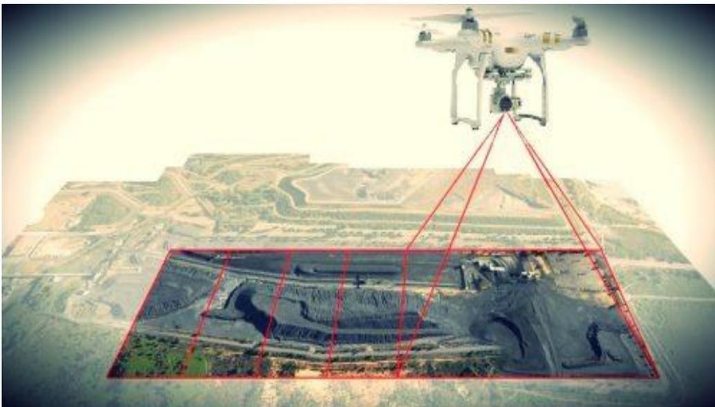
*Nota.* En esta figura se muestra el recorrido de la aeronave, según la programación del vuelo del dron en esta imagen se ve que su vuelo es rectangular con varias pasadas sobre el objetivo. Adaptado de fotogrametría con drones, por **GEOBAX**.
