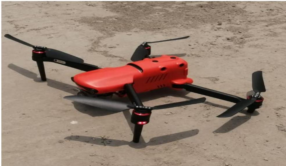
*Nota.* En esta figura se muestra el dron en el punto de control, el mismo que realizará el levantamiento fotogramétrico siguiendo el plan de vuelo.
