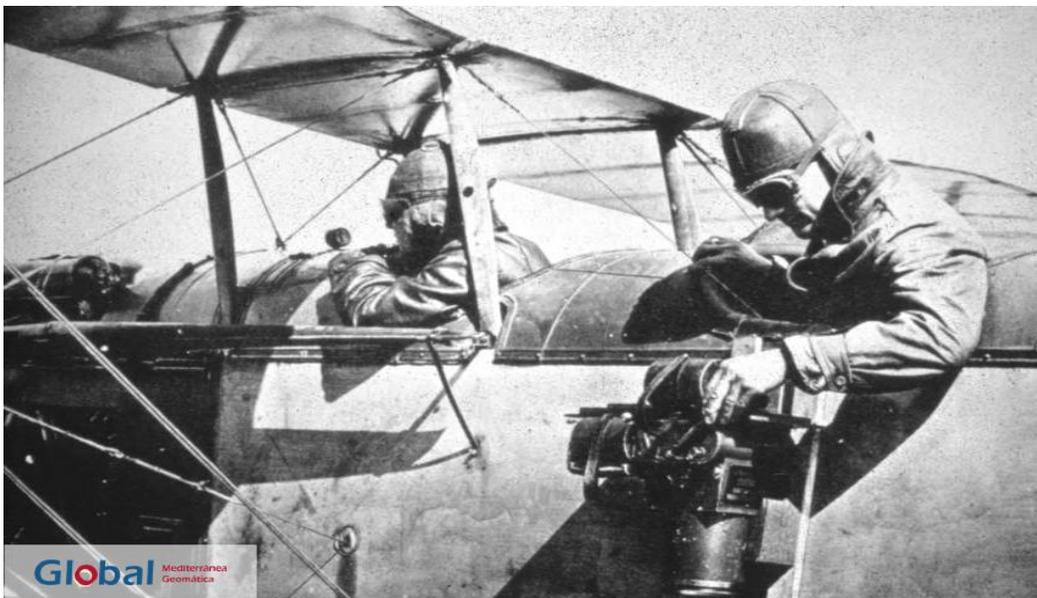
*Nota.* En esta figura se muestra el vuelo de un avión de la primera guerra mundial con las primeras cámaras fotográficas aéreas, las cuales tenían un gran tamaño. Adaptado de fotogrametría evolución y uso, por Global Mediterránea Geomática, 2018.
