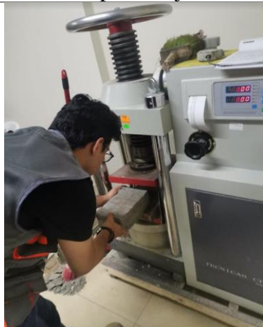
Ensayo de resistencia a la compresión a los ladrillos
