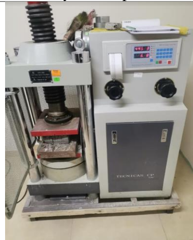
Ensayo de resistencia a la compresión a los ladrillos
