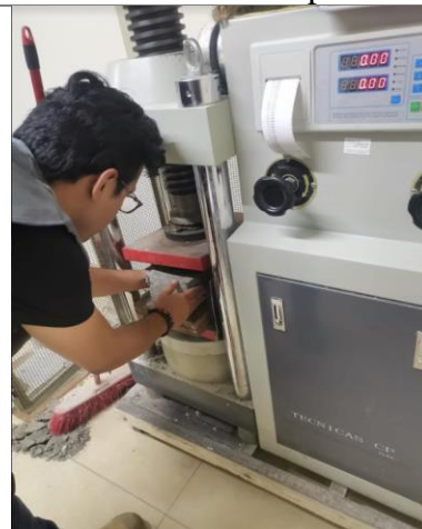
Ensayo a compresión
