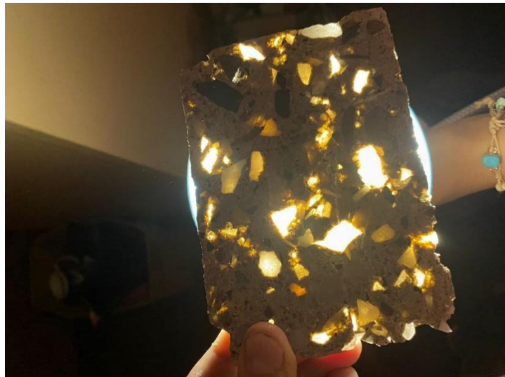
Ensayo de translucidez de un corte de ladrillo, e=2\text{ cm}
