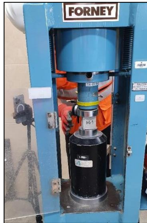
Figura 18 Ensayo a compresión de los cubos de mortero
