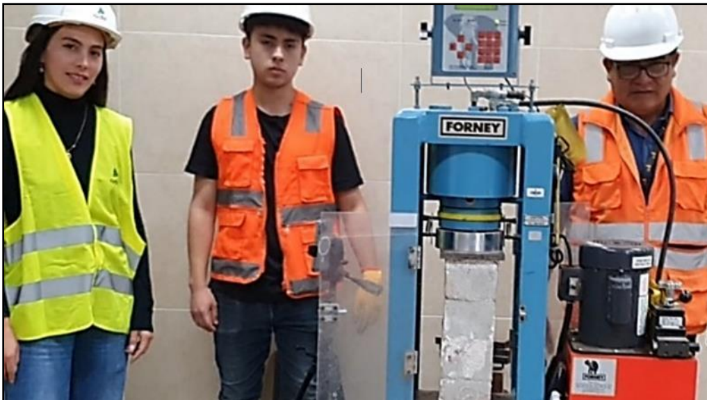
Figura 21 Ensayo a compresión de pilas de albañilería
