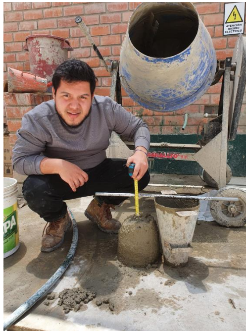
Midiendo el asentamiento del concreto fresco
