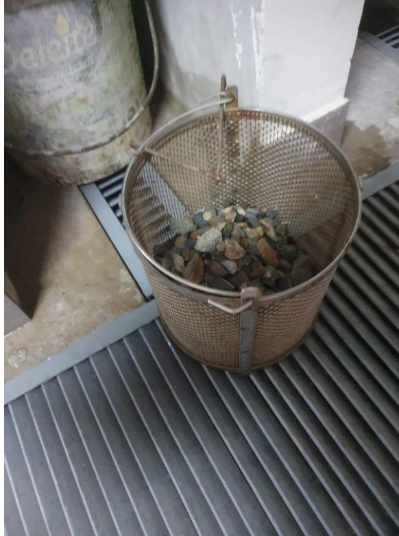
Agregado grueso seleccionado para ensayos
