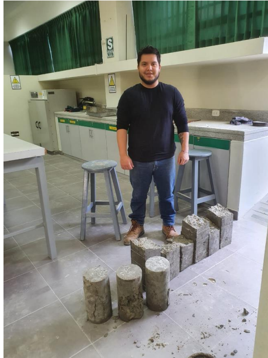
Ruptura de probetas con maquinaria para ensayos de compresión y flexión
