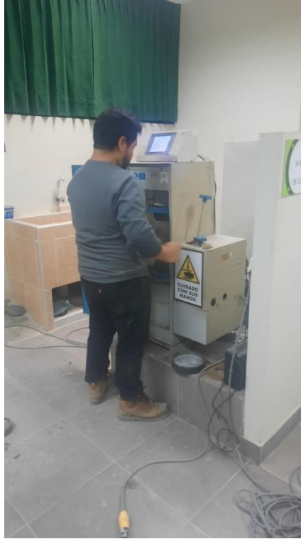
Ruptura de probetas con maquinaria
