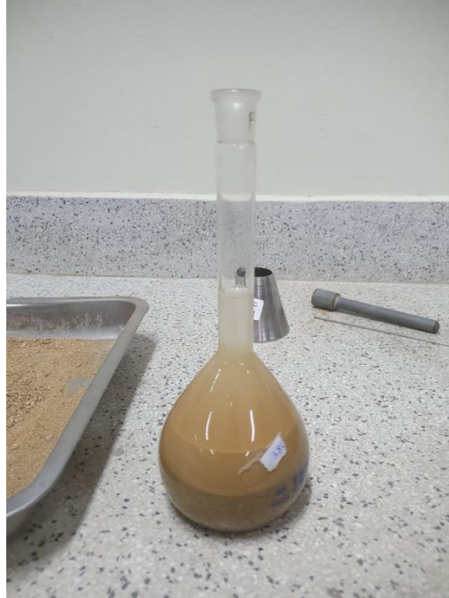
Agregado fino en ensayo de absorción
