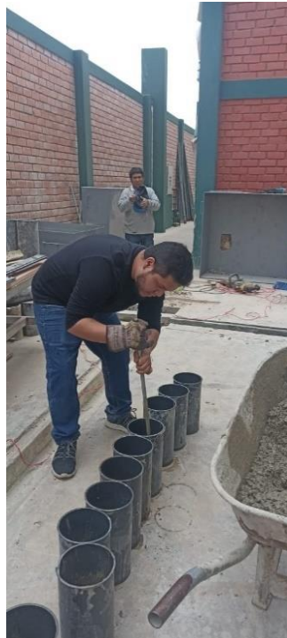
Vaciado de concreto fresco en moldes para ensayos de flexión
