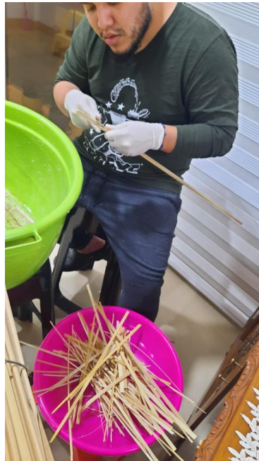
Proceso de separación de la corteza de totora del bagazo
