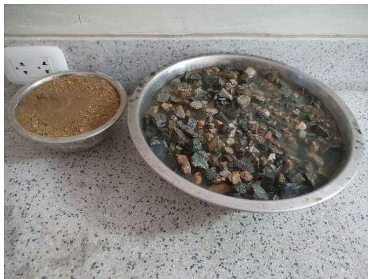
Agregado grueso en ensayo de absorción
