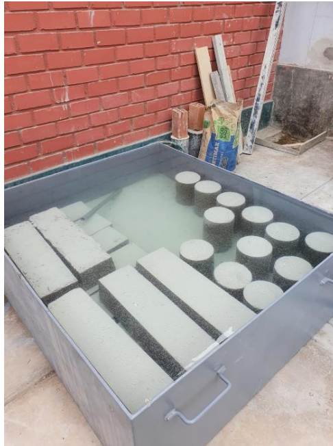
Proceso de curado de las probetas en una piscina
