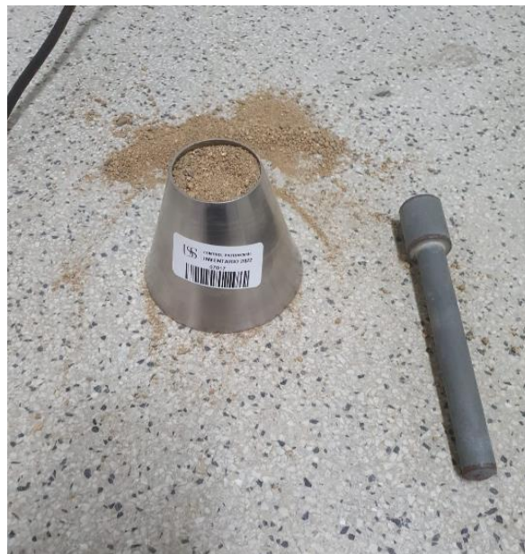
Agregado fino en ensayo de Peso unitario
