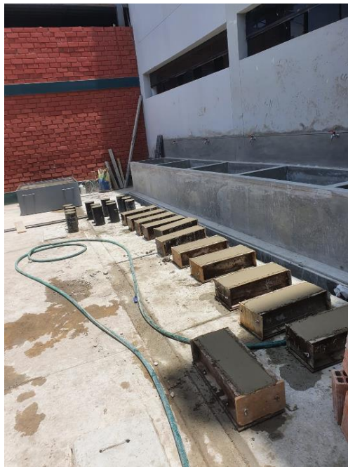
Todos los moldes fueron llenados con concreto fresco
