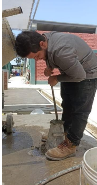
Ensayo de asentamiento en el concreto fresco con el cono de Abrams, dando golpes con varilla.
