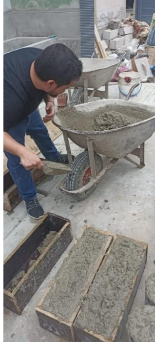
Vaciado de concreto fresco en moldes para ensayos de flexión
