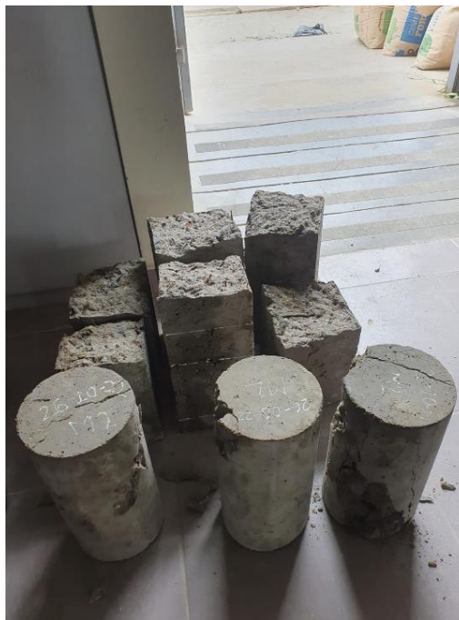
Ruptura de probetas para ensayos de compresión y flexión
