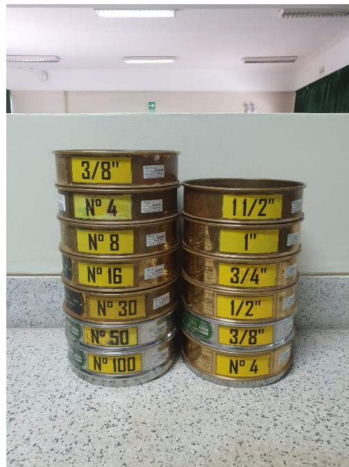
Tamices, instrumentos para el ensayo de granulometría
