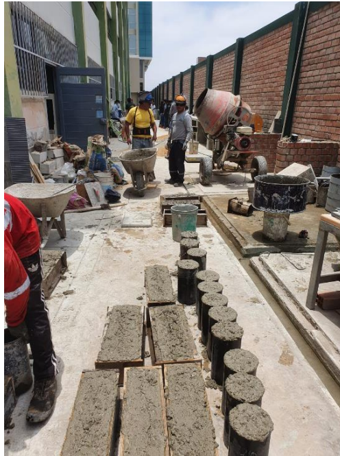
Todos los moldes fueron llenados con concreto fresco
