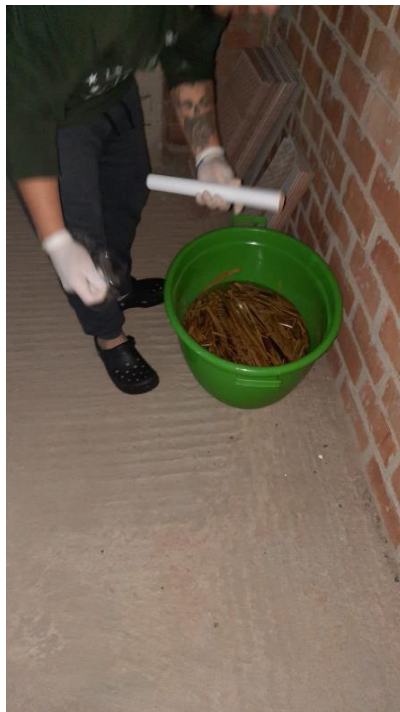
Fibras de totora en proceso de curado con Cal
