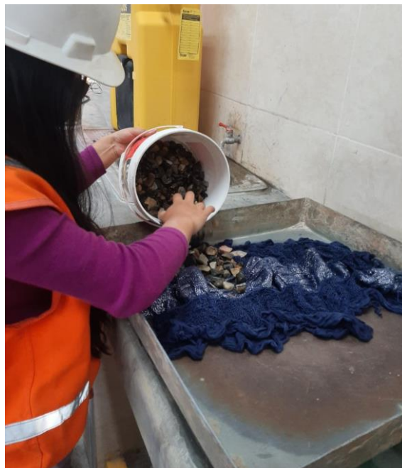
Figura 24: Ensayo de peso específico y absorción de agregados gruesos.
