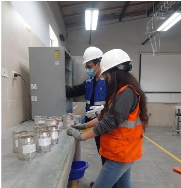
Figura 20. Ensayo de contenido de humedad de los agregados.
