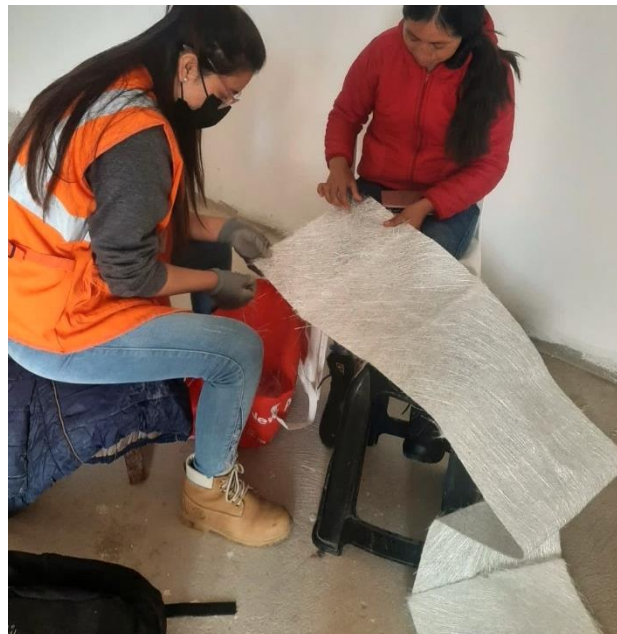
Figura 266: Deshilachado de la fibra de vidrio.
