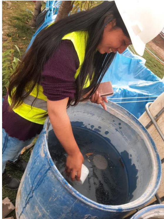
Figura 301: Curado de probetas a absorción.
