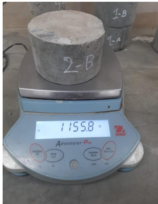
Figura 356: Peso de los especímenes después de sacarlo del horno.
