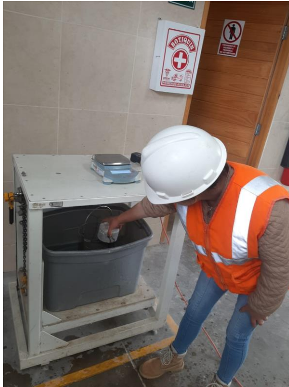
Figura 391: Especímenes suspendidos dentro del agua.
