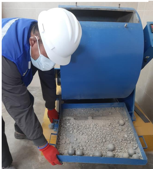
Figura 22: Ensayo de Abrasión.
