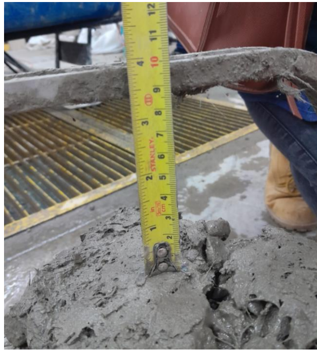
Figura 277: Slump del concreto.
