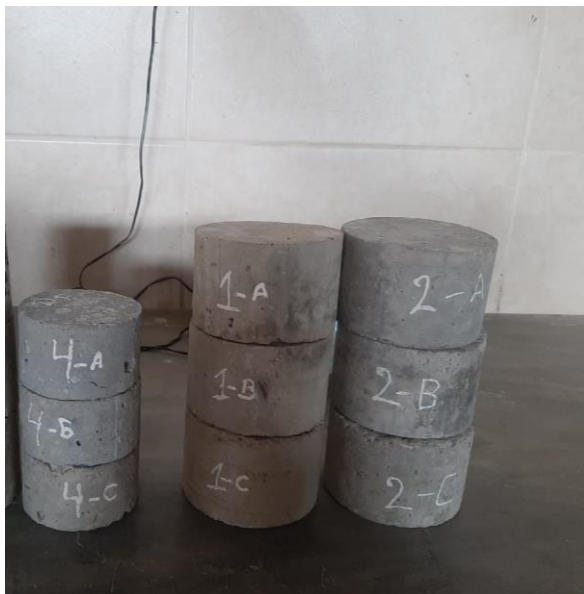
Figura 380: Especímenes después de ser hervidas para obtener su peso.
