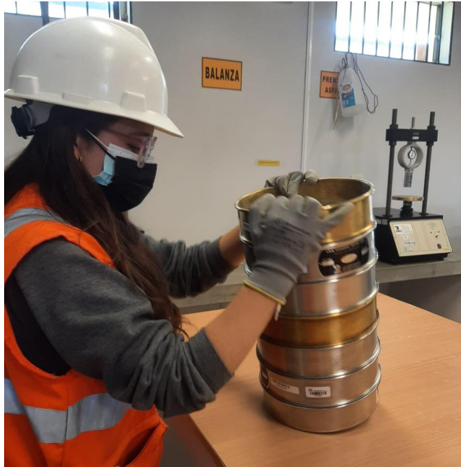
Figura 21: Ensayo de análisis granulométrico de los agregados
