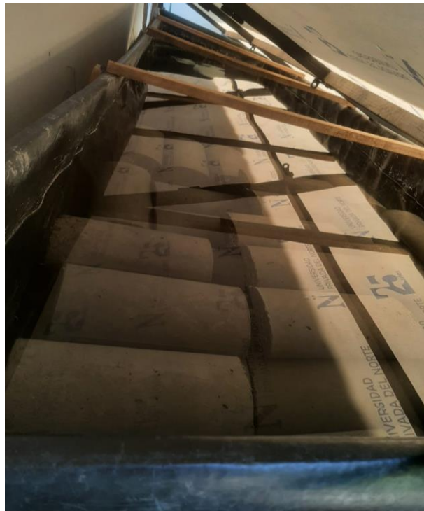
Figura 290: Curado de probetas a compresión
