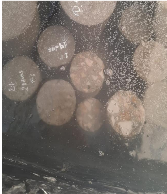
Figura 367: Especímenes sometidos por 24 horas al agua.
