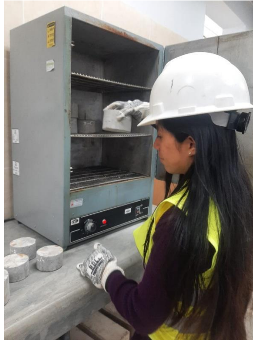
Figura 345: Especímenes sometidos por 24 horas al horno.
