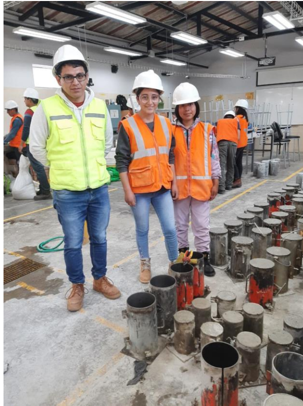
Figura 29: Desenfofrado de probetas bajo la inspección de ingeniero de laboratorio.
