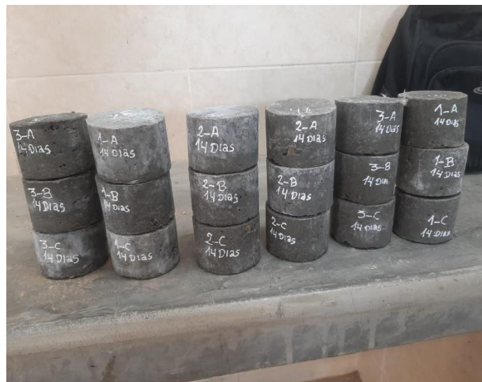
Figura 334: Especímenes para el ensayo de absorción.
