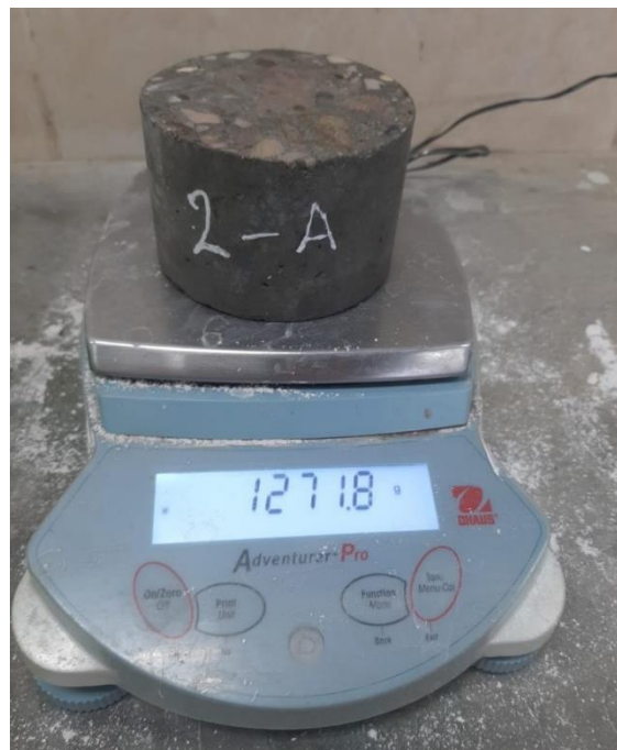
Figura 378: Peso de los especímenes después de inmersión al agua.
