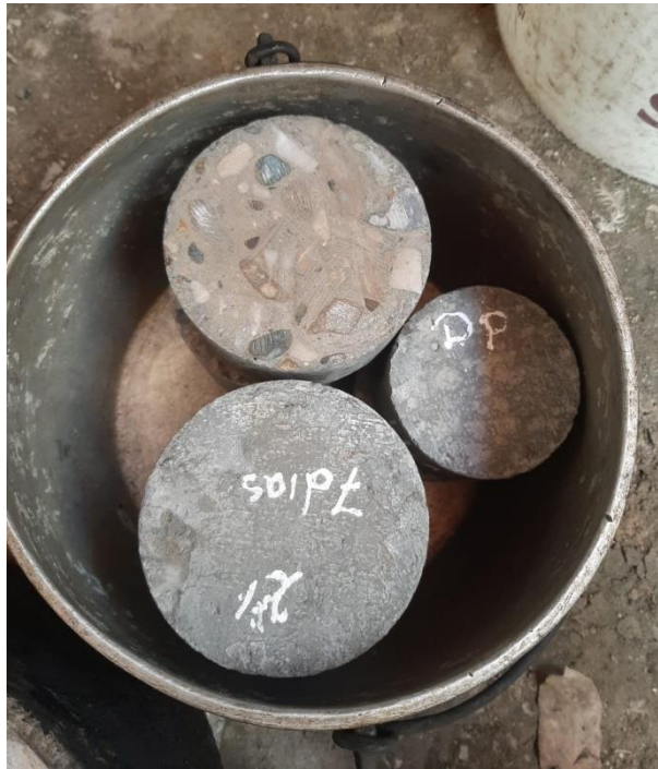
Figura 39: Especímenes sometidas a ebullición por 5 horas.
