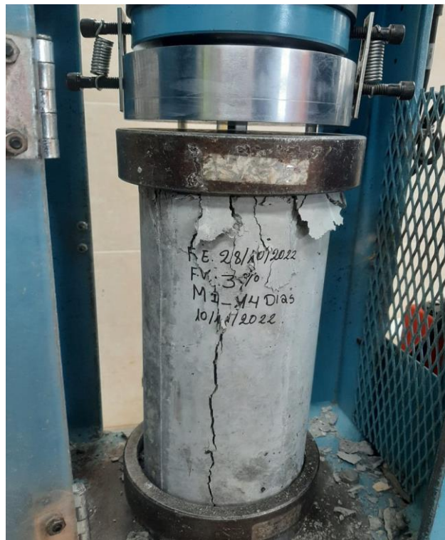
Figura 312: Probetas a compresión ensayadas.
