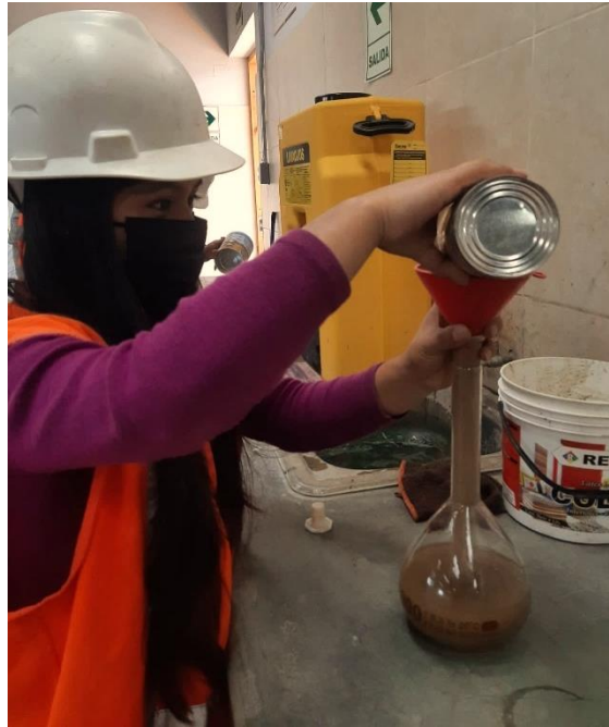
Figura 23: Ensayo de gravedad específica y absorción de los agregados finos.
