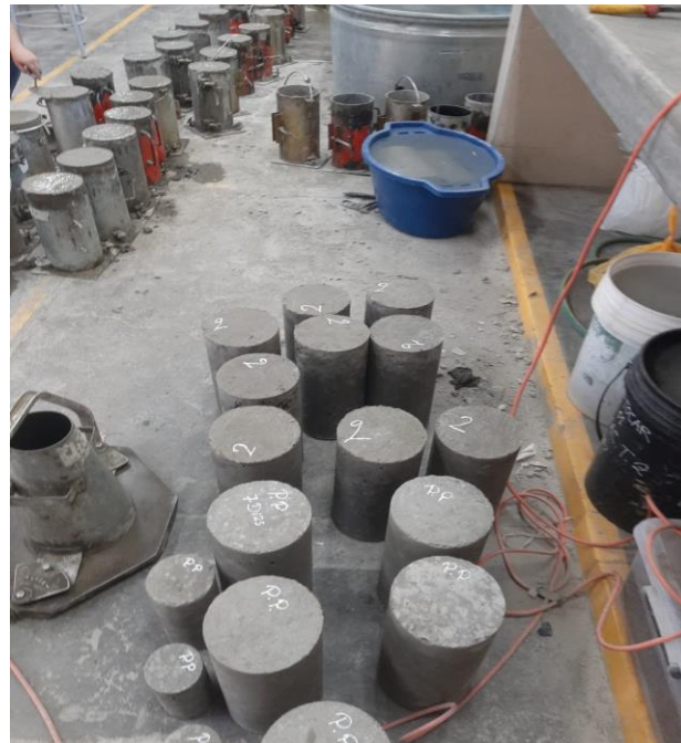
Figura 288: Elaboración de probetas para el ensayo a compresión y absorción.
