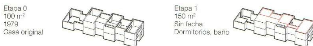
Gráfico 2.125: PREVI - Arq. Charles Correa- Etapa 0 y 1 en la evolución de la vivienda. 7
