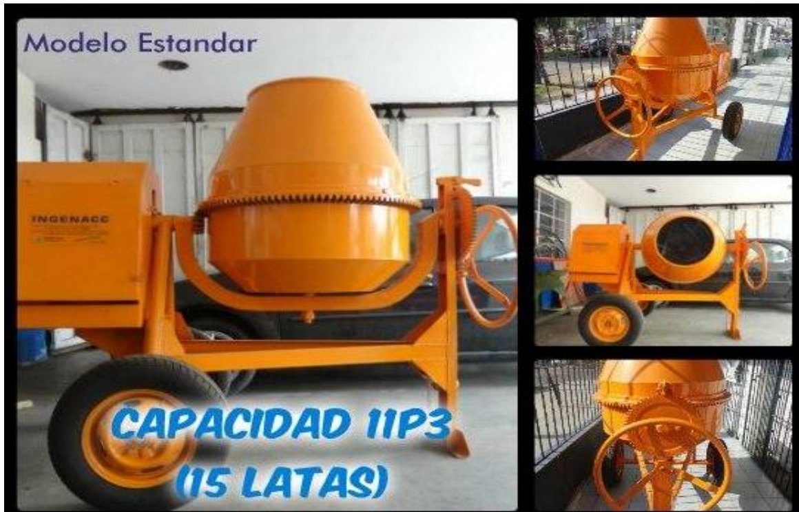
Figura N° 0013: Mezcladora tipo Trompo de Tambor Basculante 11 P3
