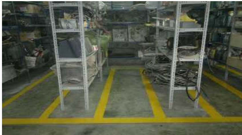
Figura N°35: Pintado márgenes de zona de accesorios
