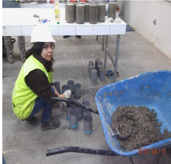
Fotografía 18: Compactando la mezcla de concreto en las probetas.
