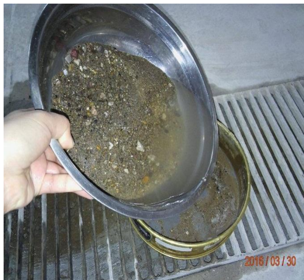
Fotografía 2: Realizando el lavado del agregado fino en la malla #200.
