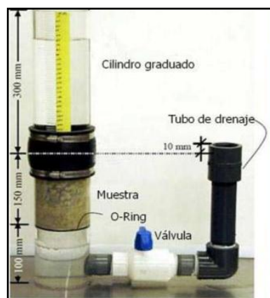
Figura 1: Permeámetro según ACI 522
