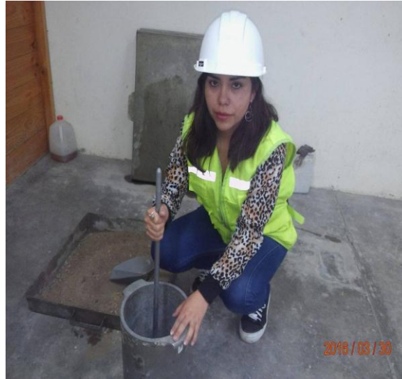
Fotografía 3: Realizando la compactación del agregado fino
