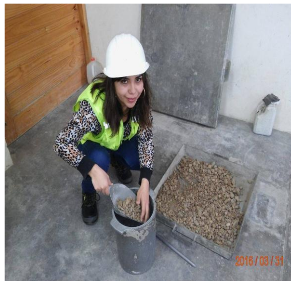
Fotografía 4: Agregando el agregado grueso para realizar la compactación
