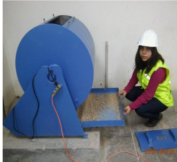
Fotografía 7: Realizando el ensayo de Abrasión
