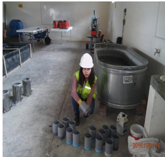
Fotografía 10: Colocando petróleo a las probetas para desmoldar con facilidad.
