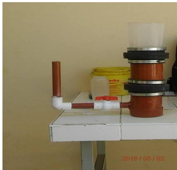
Fotografía 21: Permeámetro estipulado por el ACI 522.
