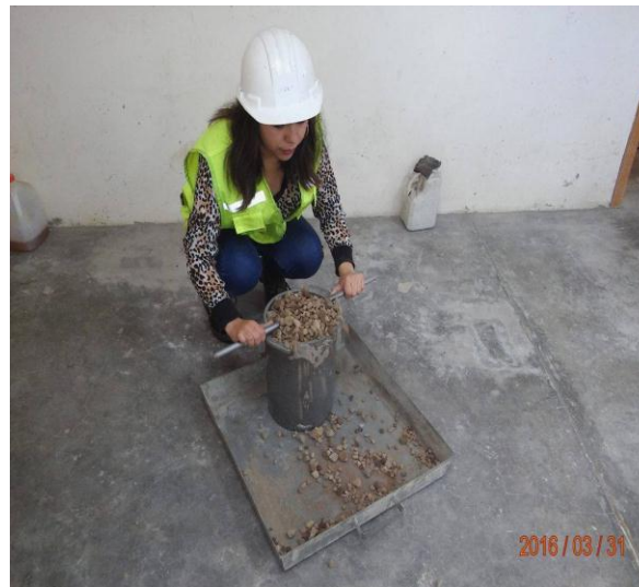
Fotografía 6: Realizando el enrasado del agregado grueso.
