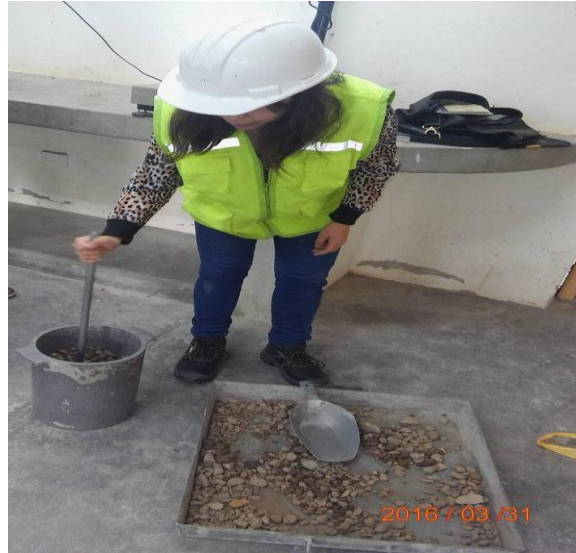
Fotografía 5: Realizando la compactación del agregado grueso.
