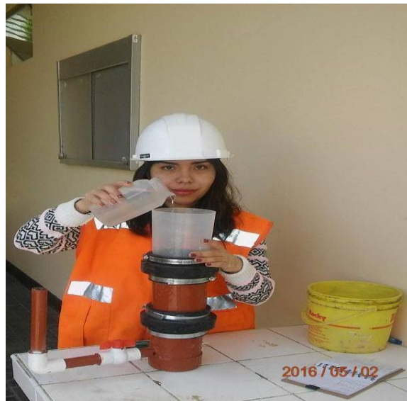
Fotografía 22: Agregando agua al cilindro del permeámetro.
