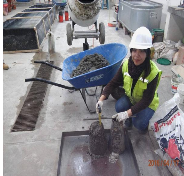
Fotografía 16: Midiendo el asentamiento del concreto.
