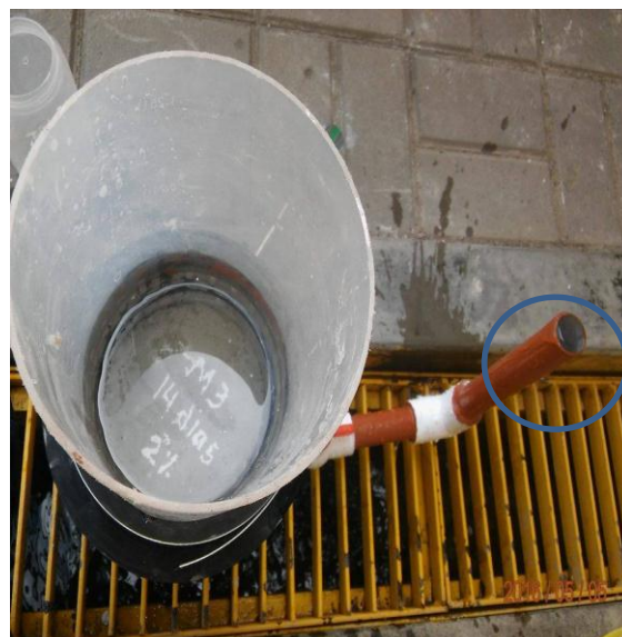
Fotografía 23: Muestra de concreto, siendo ensayada en el permeámetro, además se observa como el agua va saliendo por el tubo de drenaje
