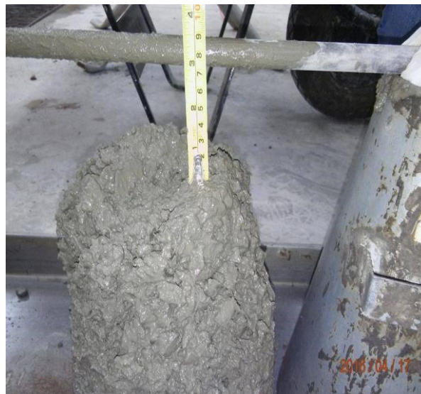
Fotografía 17: Asentamiento obtenido de 3 pulgadas.
