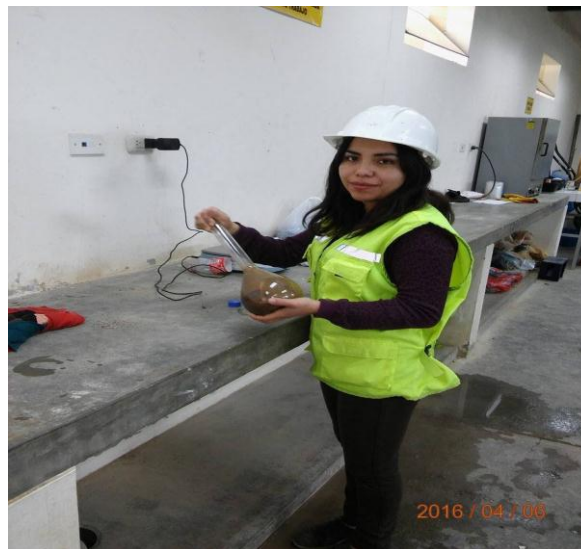
Fotografía 9: Agitando la fiola que contiene el agregado fino y agua.
