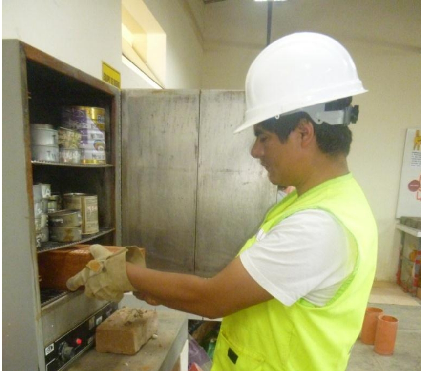
Fotografía 44. Bloque de adobe en el horno durante 24 horas para ensayo de absorción
