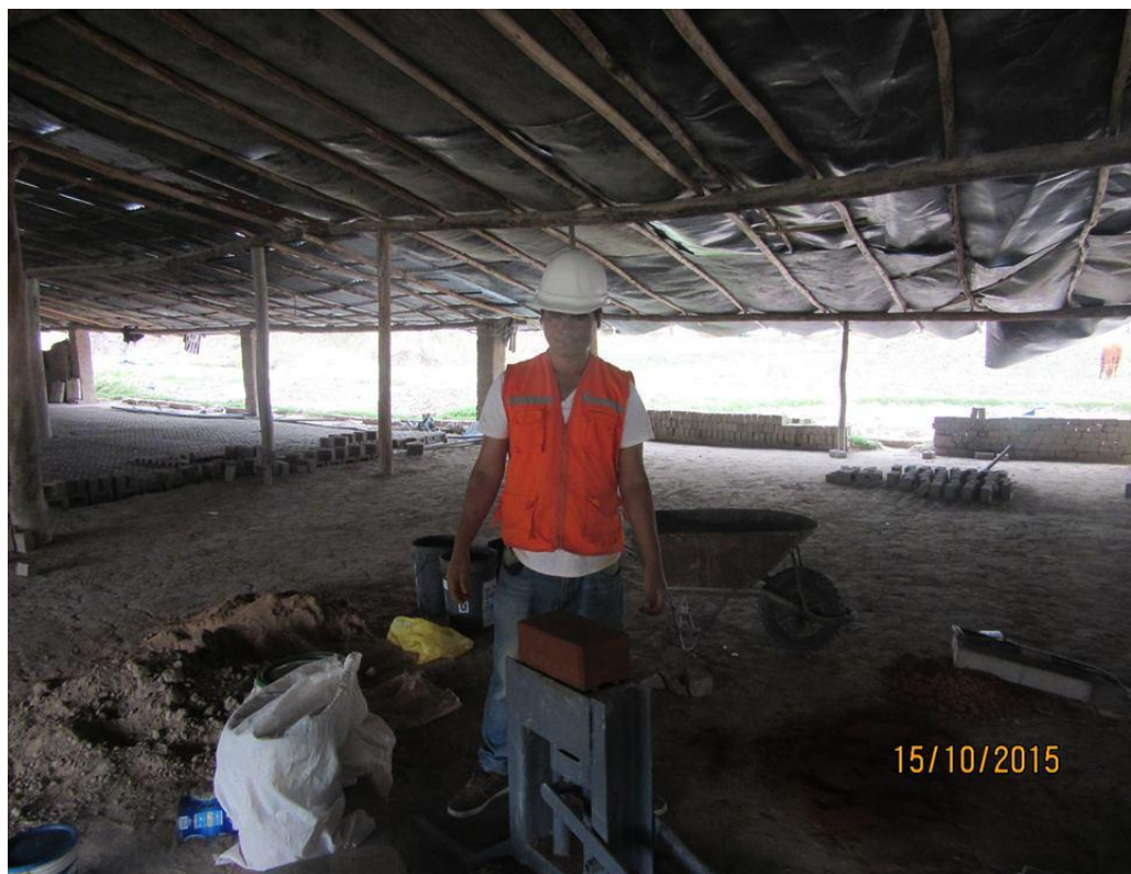
Fotografía 35. Elaboración de adobes con la máquina CINVA RAM en la cantera.
