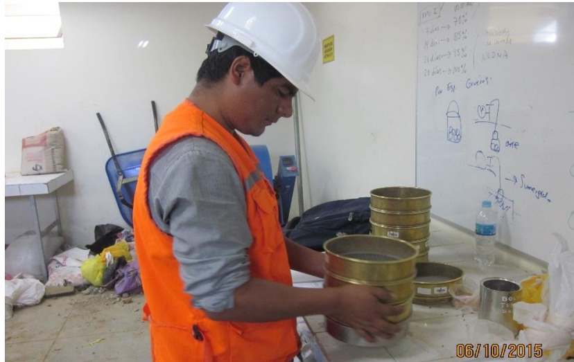
Fotografía 7. Realizando la granulometría del material lavado después de secarse en el horno
