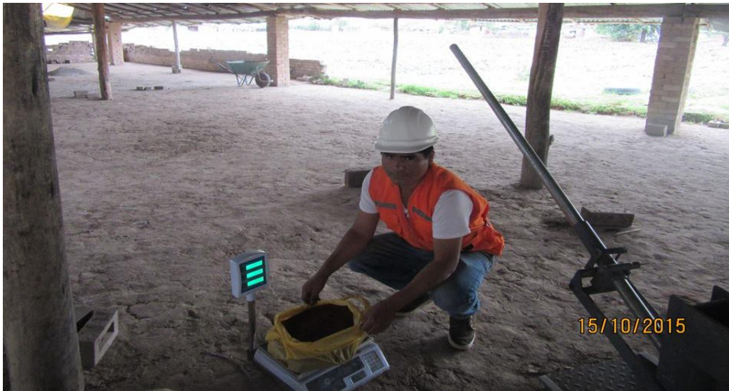
Fotografía 11. Peso de la tierra para elaboración de adobe
