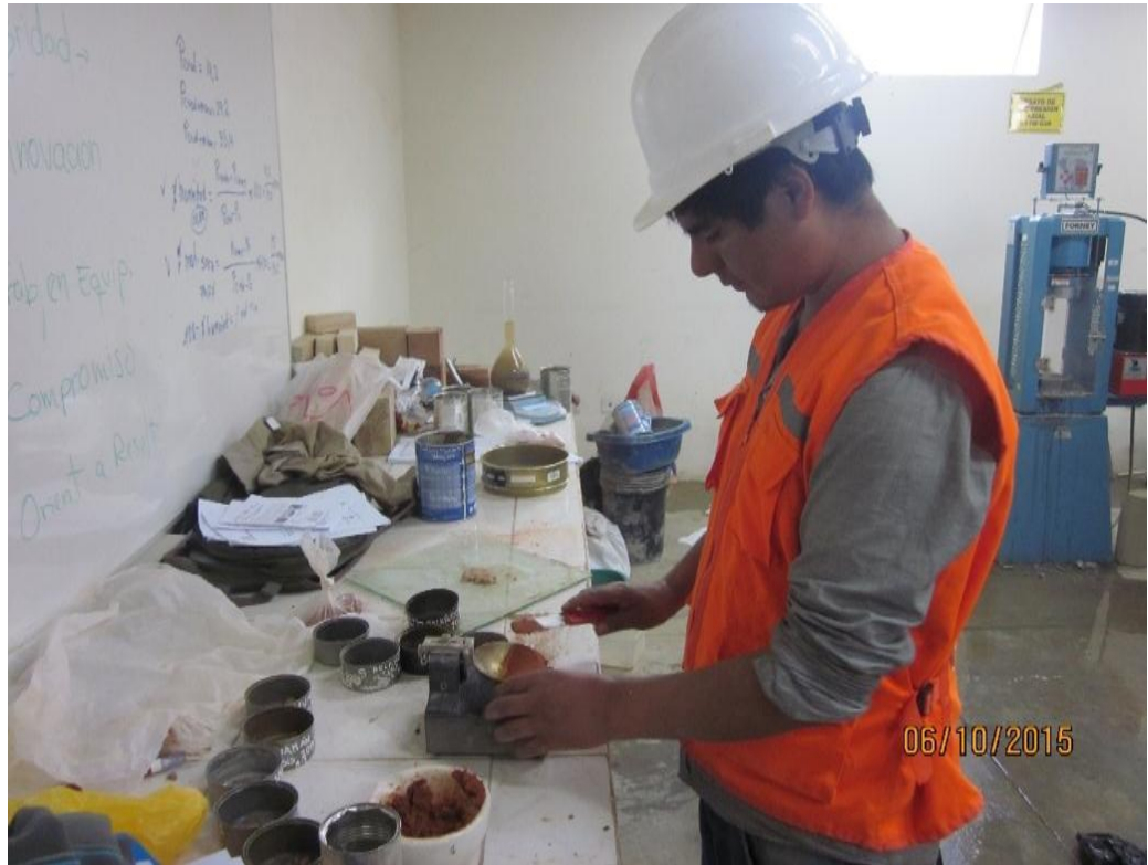
Fotografía 24. Realizando límite líquido y plástico
