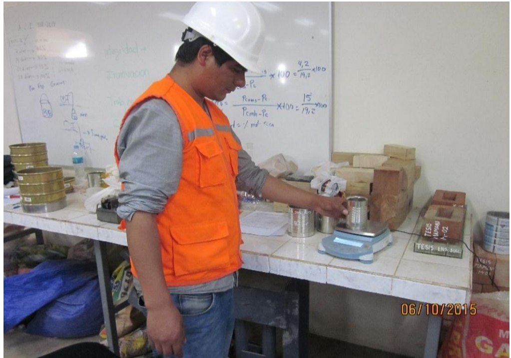
Fotografía 20. Peso de las taras con la muestra para contenido de humedad.
