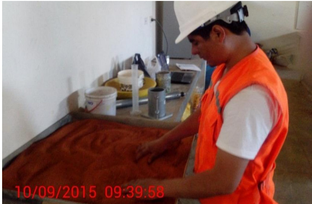
Fotografía 26. Mezclando la muestra para realizar el Proctor
