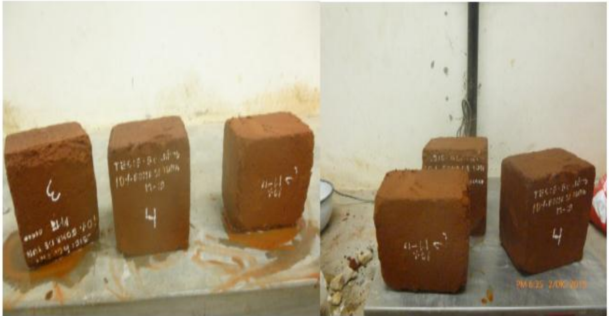
Fotografía 49. Adobe con 5% de goma de tuna sumergido en agua durante 24 horas si resiste al agua.
