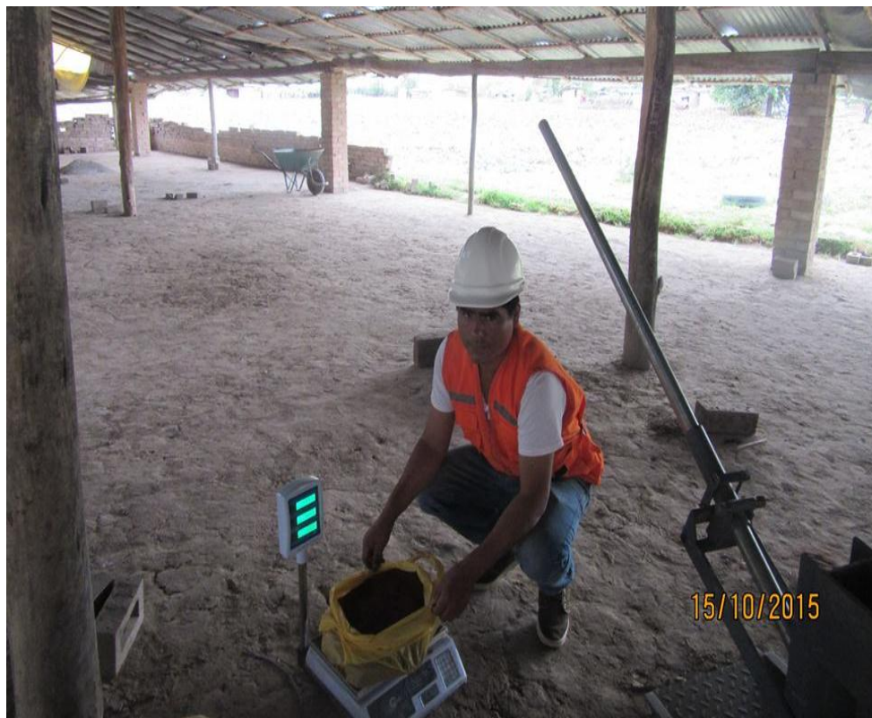
Fotografía 31. Peso de la muestra para elaboración de adobe compactado.
