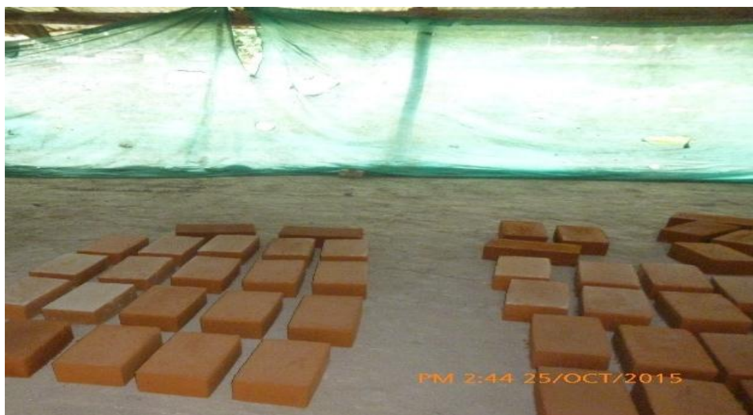
Fotografía 14. Adobe compactado y estabilizado con % de goma de tuna
