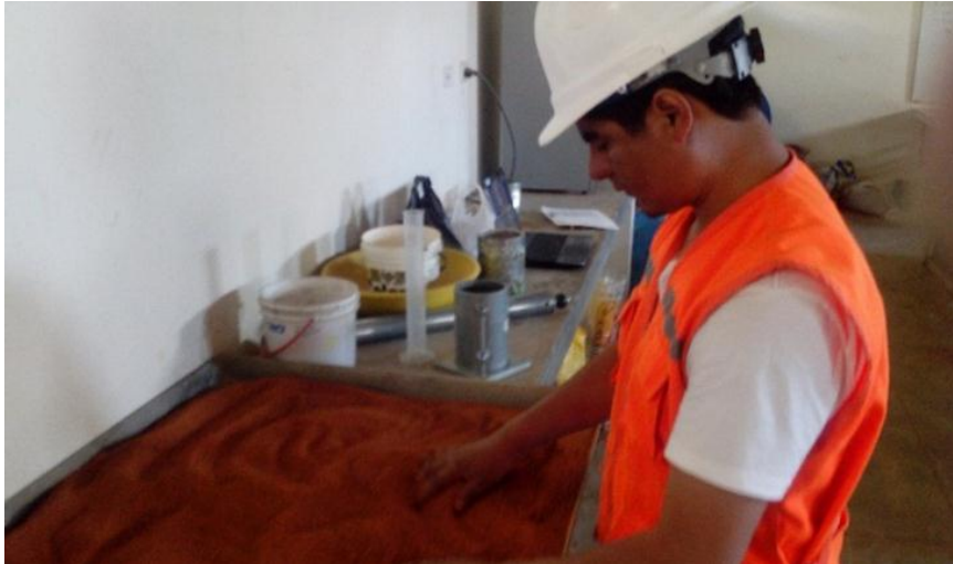
Fotografía 9. Mezclando la muestra para realizar el Proctor
