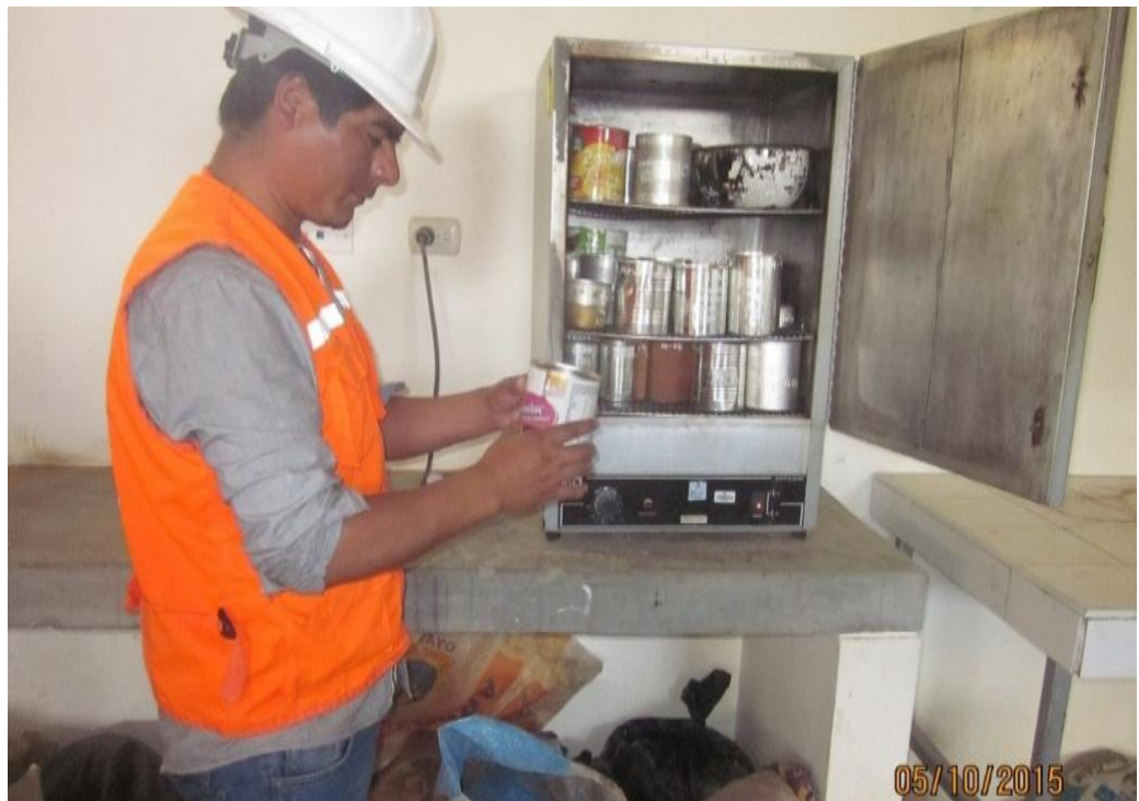
Fotografía 21. Muestra secada al horno para contenido de humedad durante 24 horas
