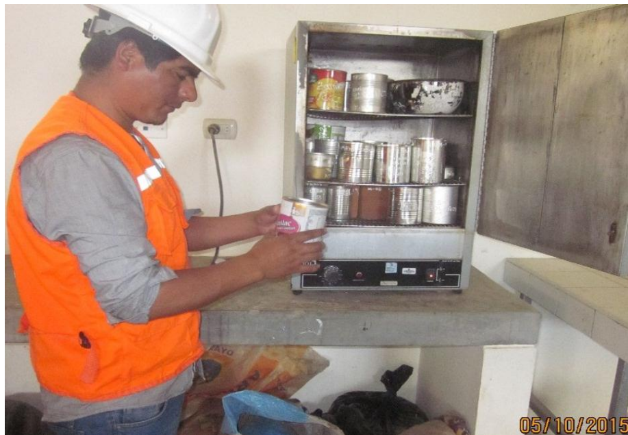
Fotografía 6. Colocación de la muestra en el horno
