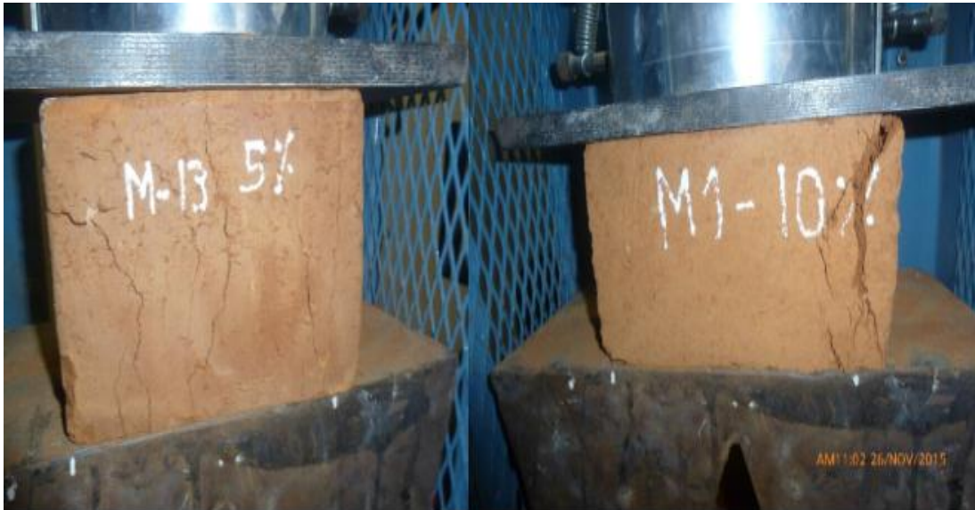
Fotografía 42. Ensayo a compresión del bloque de adobe en mitades con 5% de goma de tuna.
