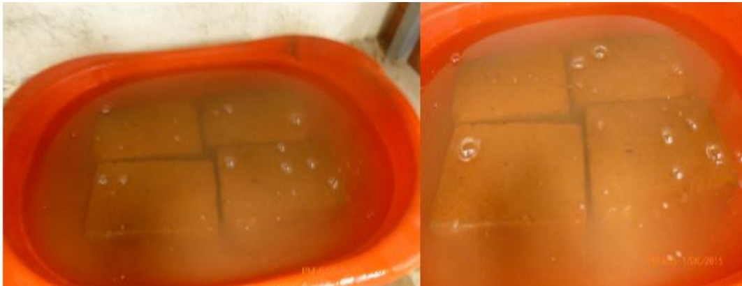
Fotografía 47. Mitades de adobe para ensayo de
