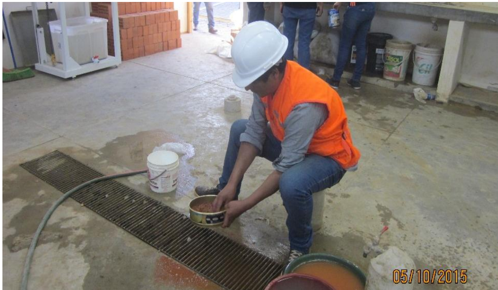
Fotografía 5. Realizando la granulometría método de lavado, ya que es un material arcilloso
