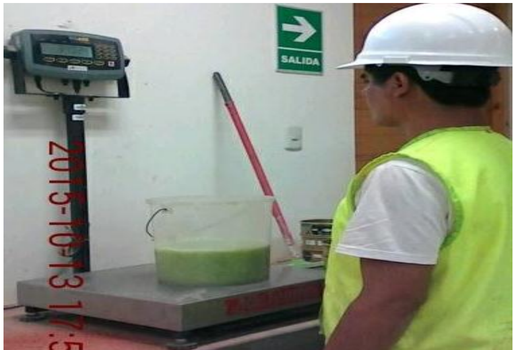
Fotografía 25. Pesando la goma de tuna para realizar el Proctor
