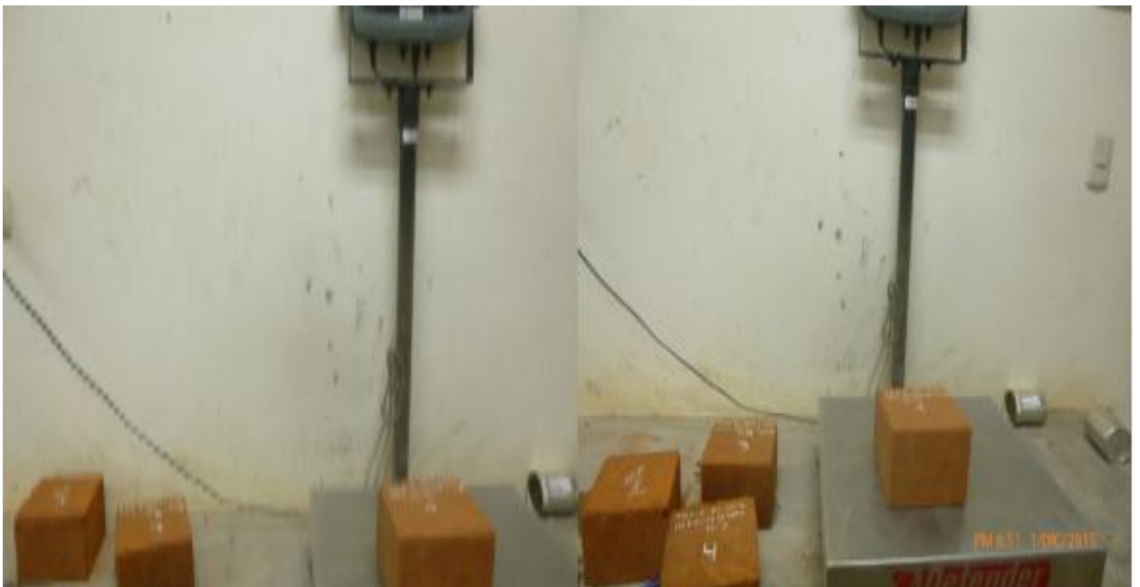
Fotografía 45. Adobe con 15% de goma de tuna sumergido en agua durante 24 horas no resiste al agua.
