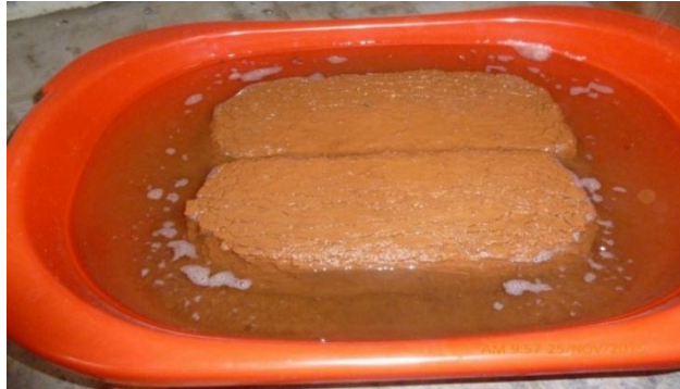
Fotografía 46. Adobe con 15% de goma de tuna sumergido en agua durante 24 horas no resiste al agua.
