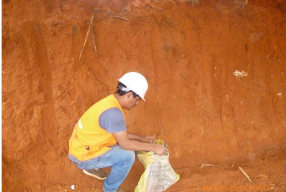
Fotografía 15. Material extraído de calicata en el caserío Shaullo Chico distrito Baños del Inca
