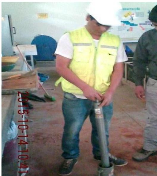
Fotografía 10. Compactación Proctor Modificado
