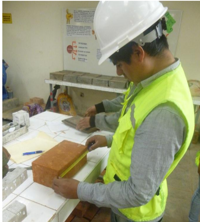
Fotografía 39. Sacando medidas exactas del bloque de adobe
