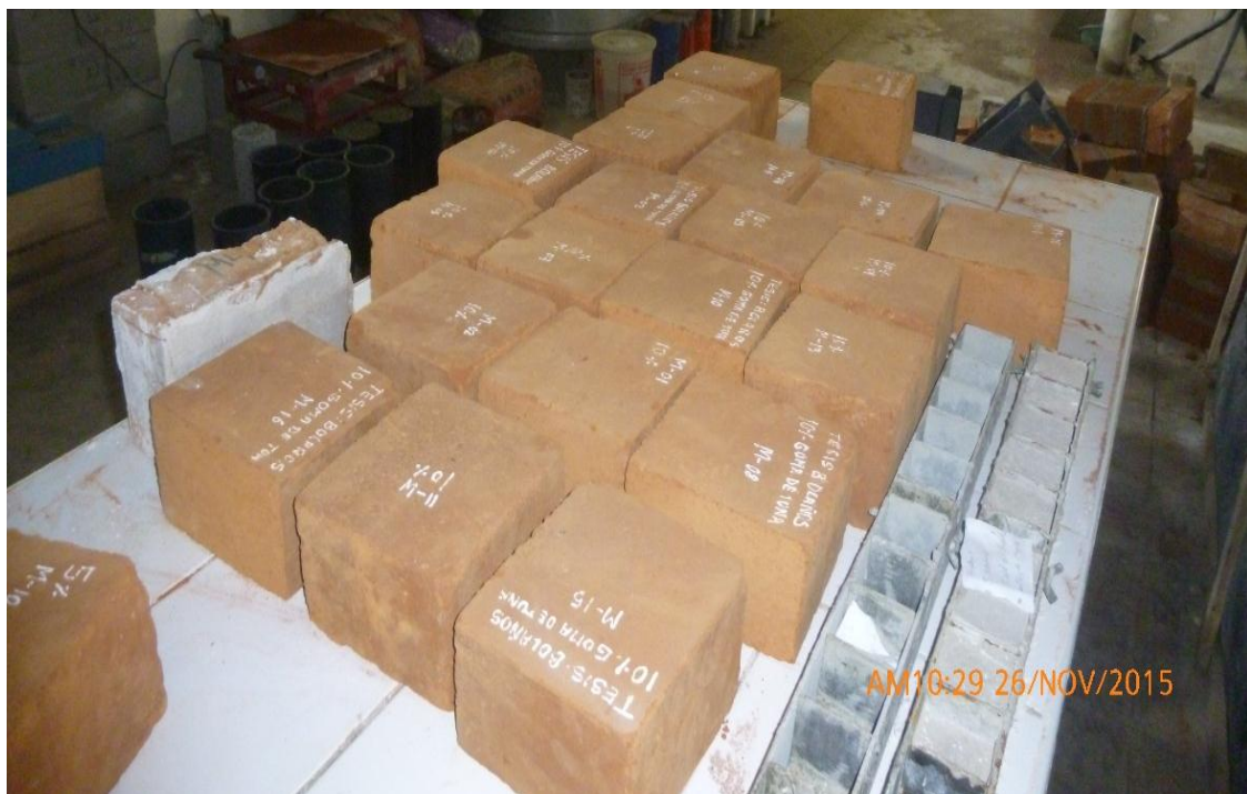
Fotografía 41. Bloque de adobe en mitades para el ensayo a compresión.
