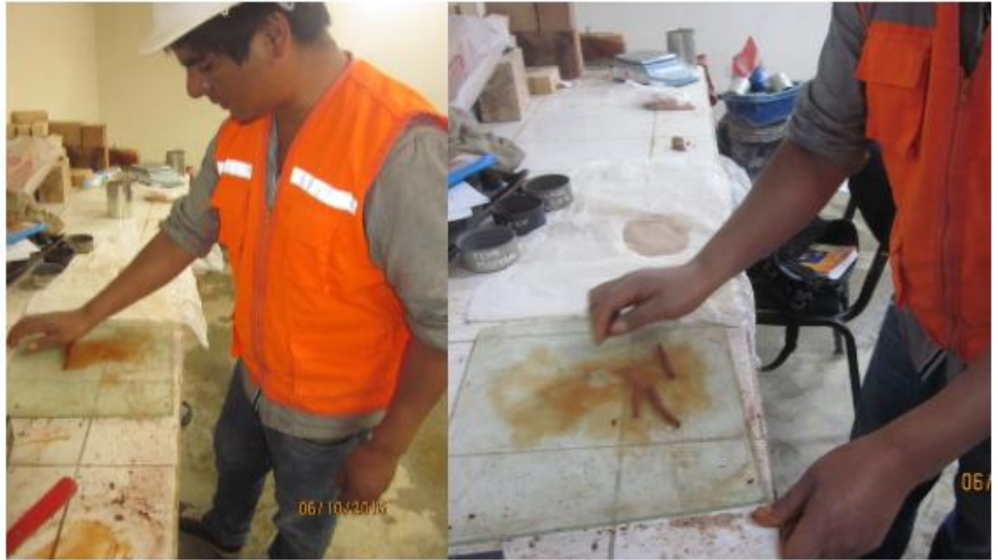
Fotografía 30. Realizando gusanitos para Límite plástico
