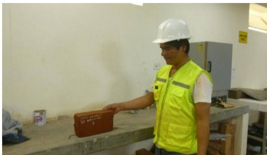
Fotografía 48. Adobe con 5% de goma de tuna sumergido en agua durante 24 horas si resiste al agua.
