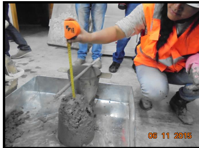
Figura N° 5: Cono de Abrams para ensayo de revenimiento
