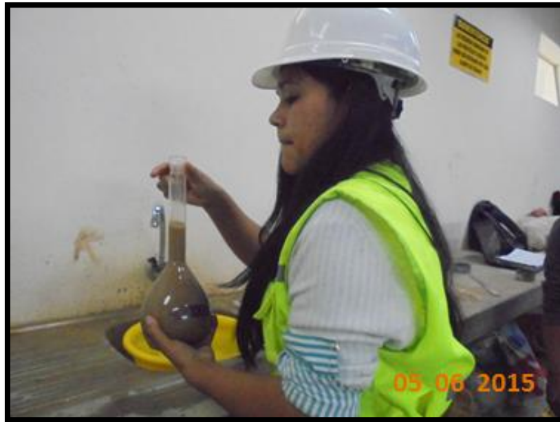
FOTO N° 11: Ensayo peso específico del agregado fino.
