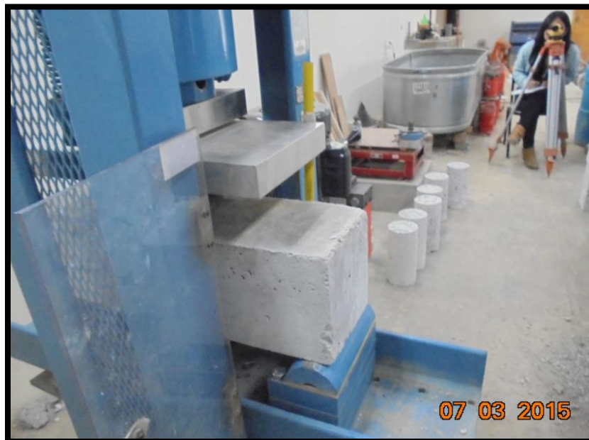
FOTO N° 28: Ensayo de resistencia a flexión de vigas
