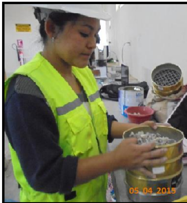
FOTO N° 4: Tamizado de agregado grueso por las mallas estándar.
