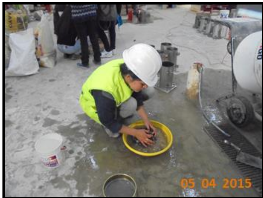
FOTO N° 8: Lavado de agregado para ensayo que pasa por tamiz #200.
