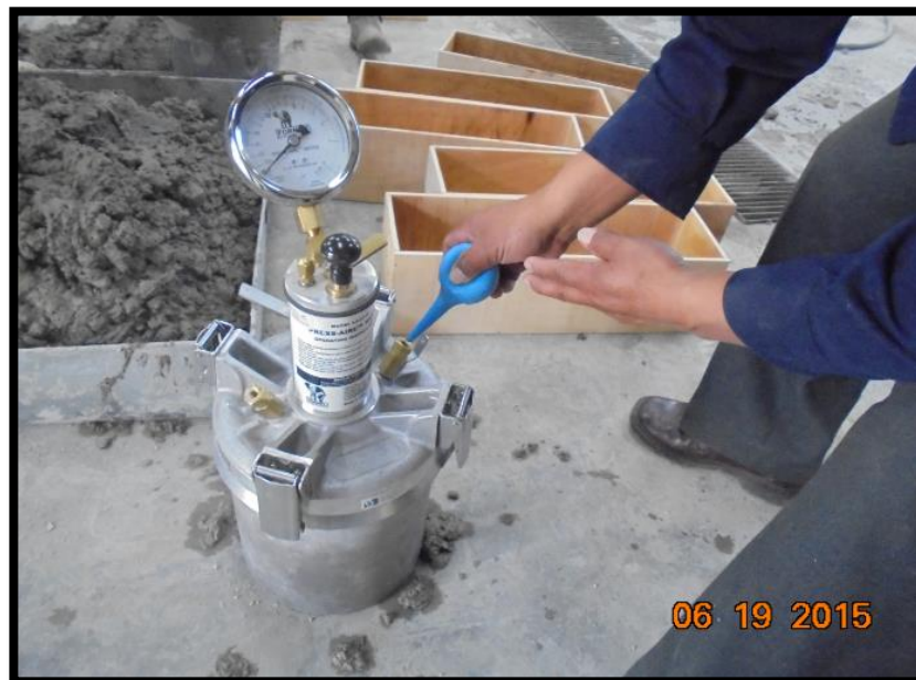
FOTO N° 24: Ensayo de contenido de aire en mezcla de concreto por el método de presión
