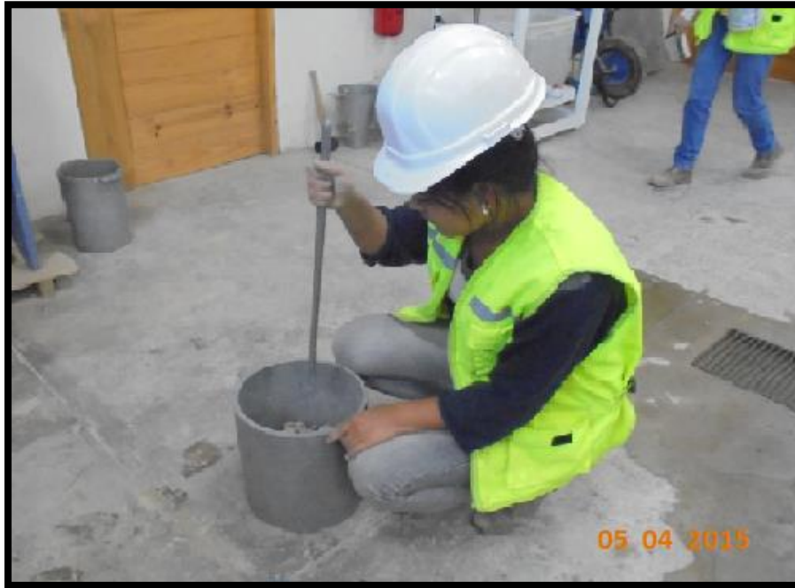
FOTO N° 5: Ensayo Peso Unitario Compactado del agregado grueso.
