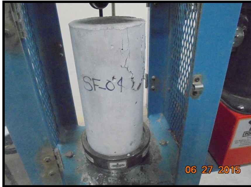
FOTO N° 27: Ensayo de resistencia a compresión de probetas a los 14 días
