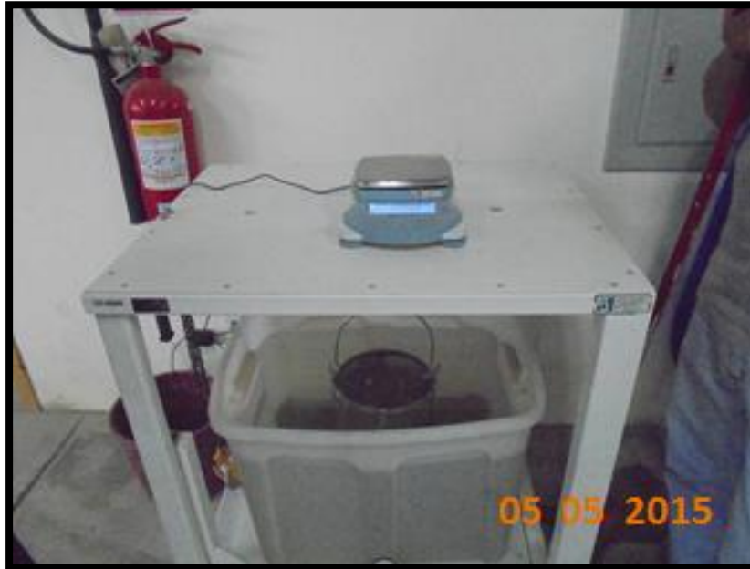
FOTO N° 9: Peso sumergido de la canastilla y el agregado
