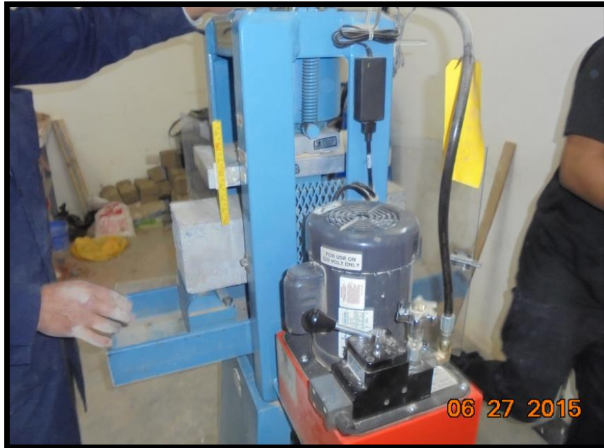
FOTO N° 25: Viga de concreto a ser ensayada.
