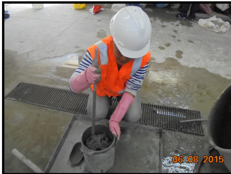
FOTO N° 16: Ensayo de peso unitario del concreto fresco.
