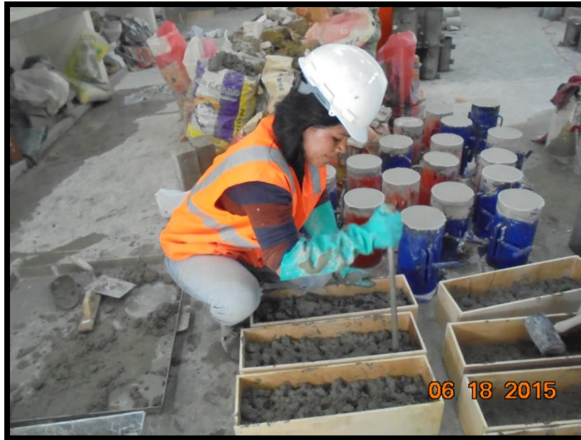
FOTO N° 23: Elaboración de vigas en moldes de triplay.
