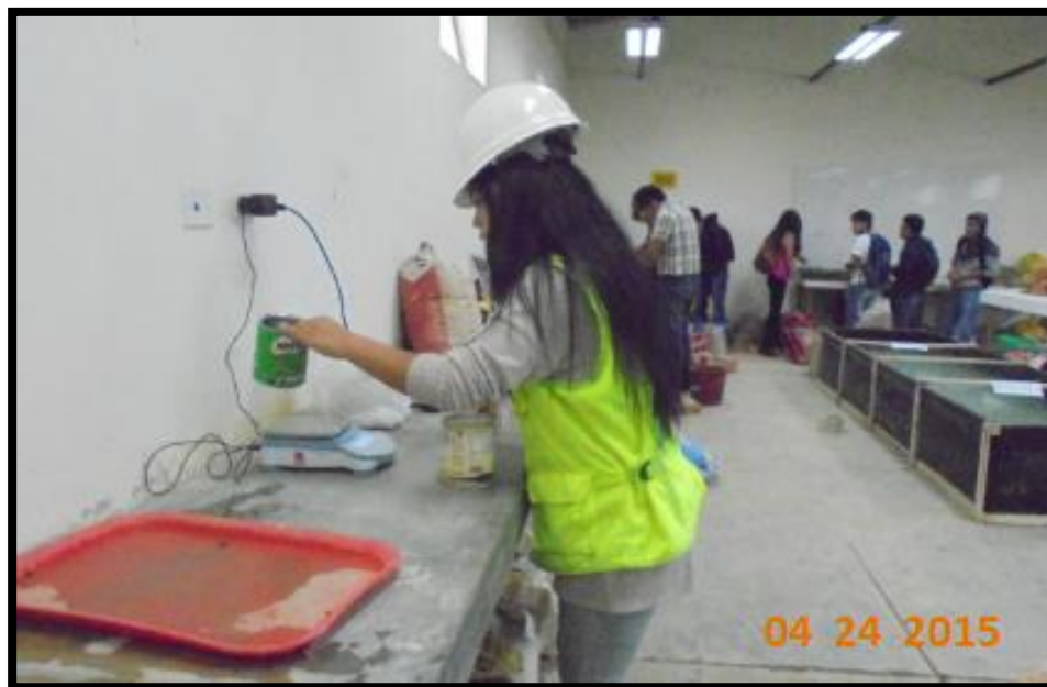
FOTO N° 2: Peso de material húmedo para ensayo de contenido de humedad.
