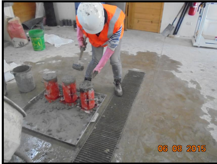
FOTO N° 17: Elaboración de probetas cilíndricas.
