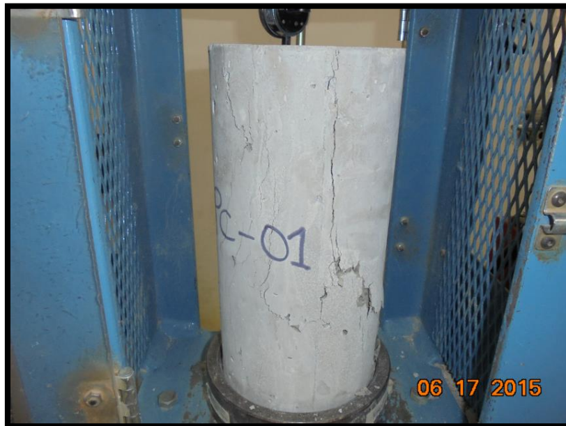
FOTO N° 20: Ensayo de resistencia a la compresión de probetas cilíndricas a los 07 días.
