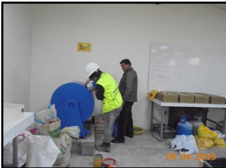
FOTO N° 6: Colocación de material a la Máquina de los ángeles para ensayo de abrasión.
