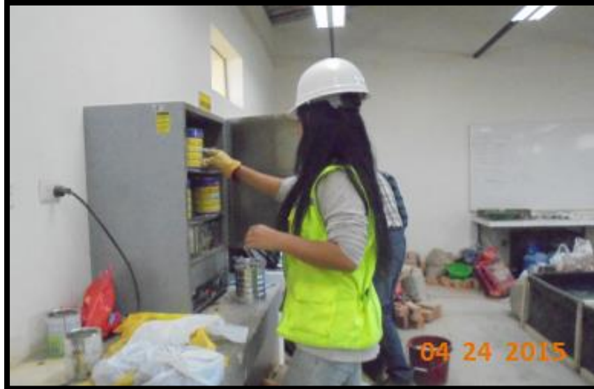
FOTO N° 3: Colocación de material húmedo en estufa por 24 hrs.
