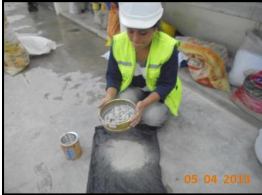
FOTO N° 7: Tamizado de material después de 500 revoluciones en la máquina de los ángeles por la malla N°12
