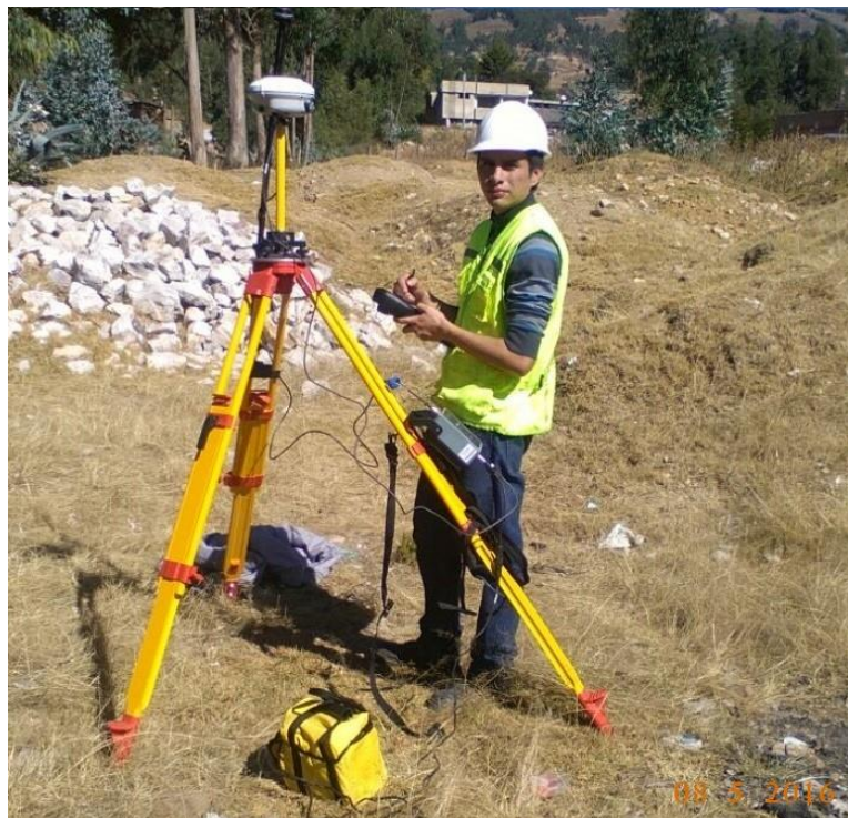
Fotografía N° 8. Manejo de GPS diferencial para levantamiento topográfico.
