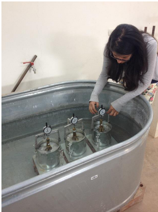
Toma fotográfica n.º 16. Colocación de muestras al agua para ensayo de hinchamiento
