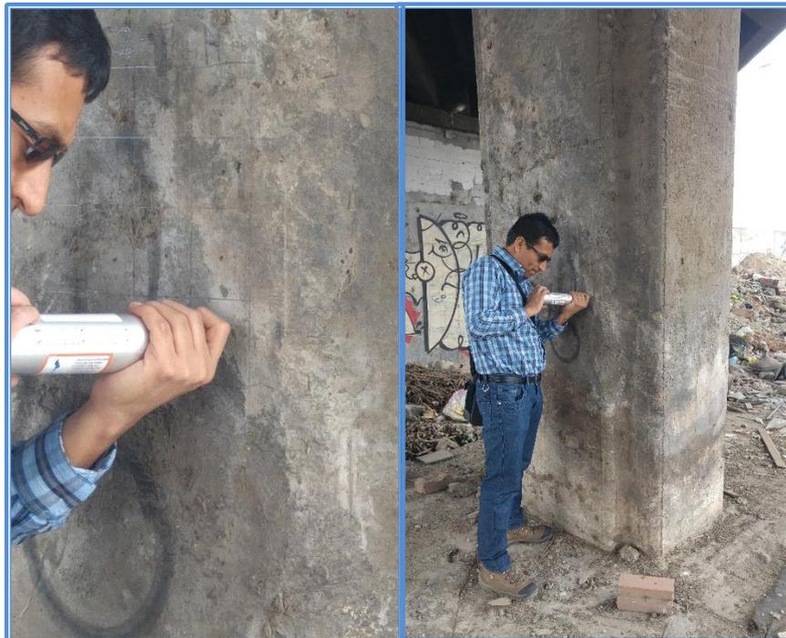
Figura 18: Prueba del Esclerómetro en Pilar P4 – PCH
