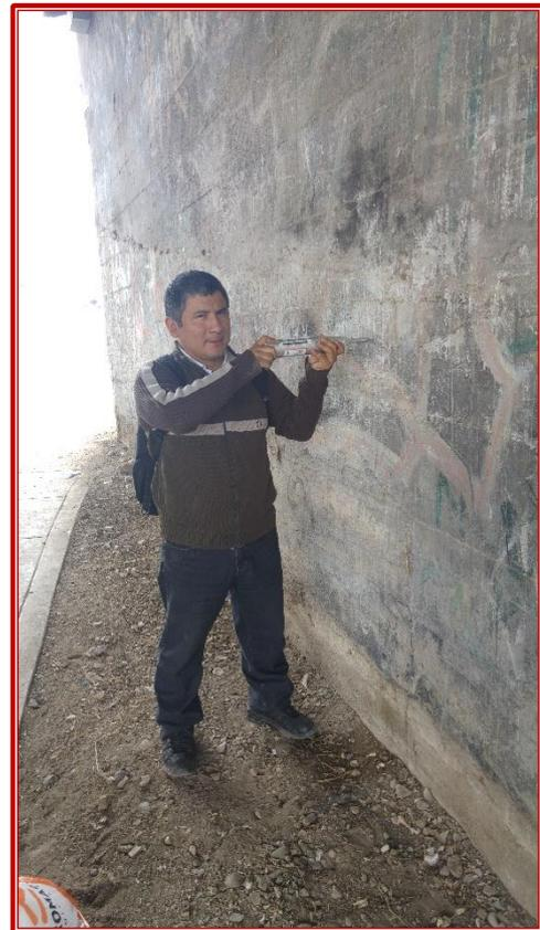
*Figura 14: Posición correcta del Esclerómetro
