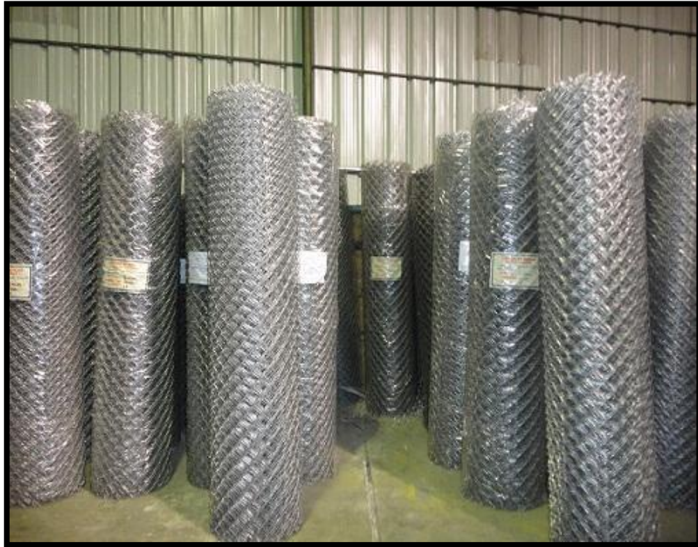
Figura n.º 16 Rollos de malla olímpica de alambre galvanizado
