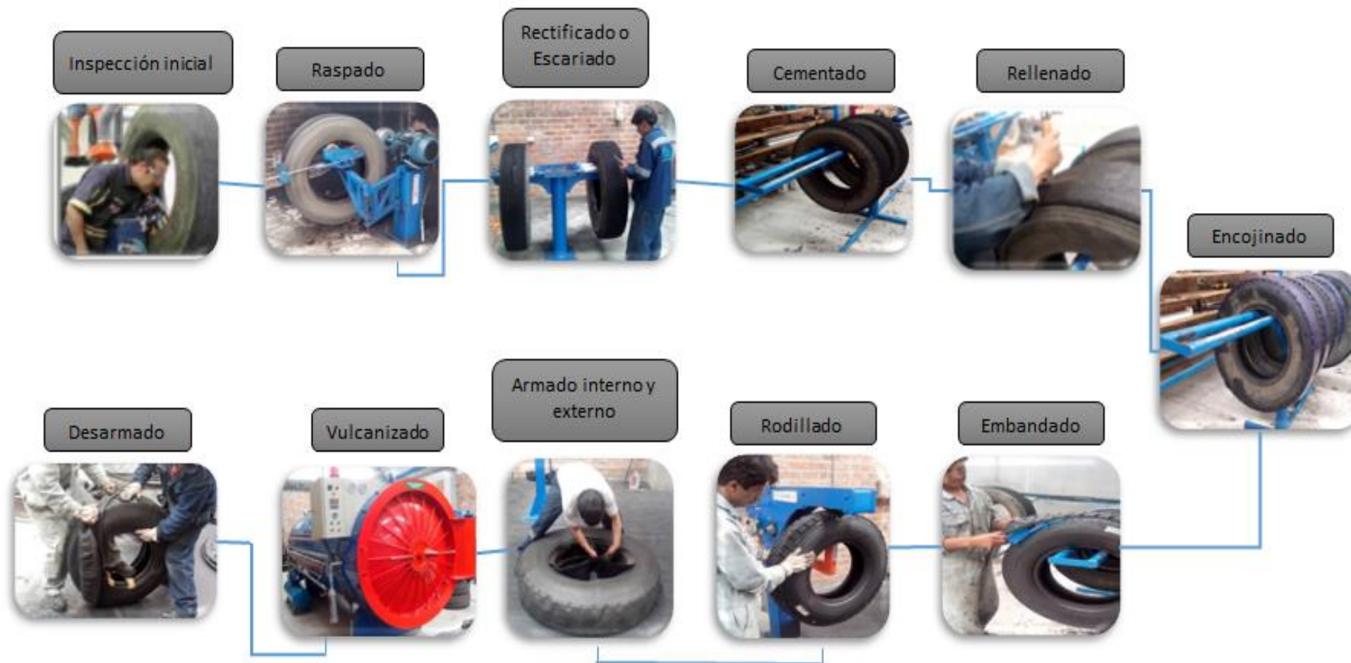
Figura n° 39: Proceso productivo del reencauchado de neumático Fuente: Elaboración propio
