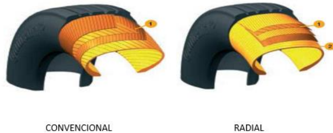
Figura n° 18: Clasificación de neumático por construcción Fuente: Moscoso (2012)
