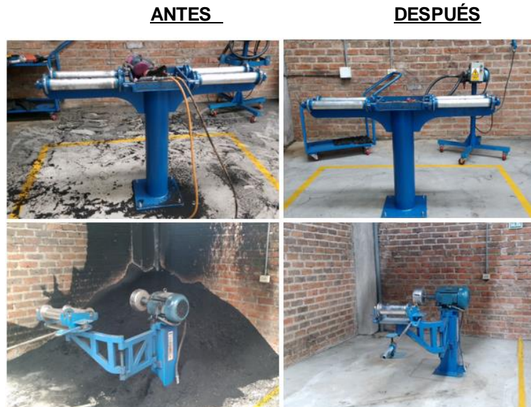
Figura n° 68: Condiciones de trabajo del área de raspado y rectificado Fuente: Elaboración propia
