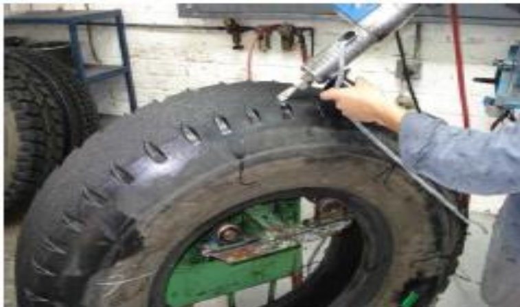
Figura n° 25: Rellenado Fuente: Moscoso (2010)
