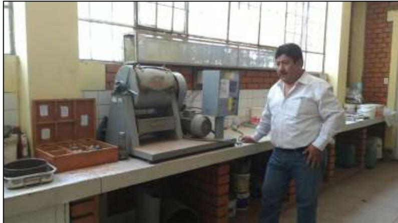
*Figura 24: Molino de Bond en Laboratorio de conminución UNSA.*
