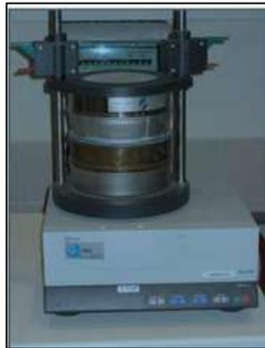
*Figura 25: Rotap para determinar distribución granulométrica en laboratorio de conminución UNSA.*
