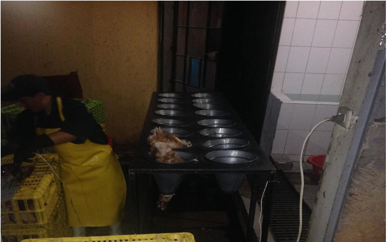
Operario colocando aves en la mesa de sacrificio (escaldadora)
