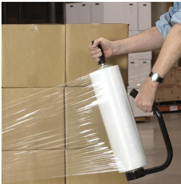
Figura 50. Instrumento de protección secundaria
