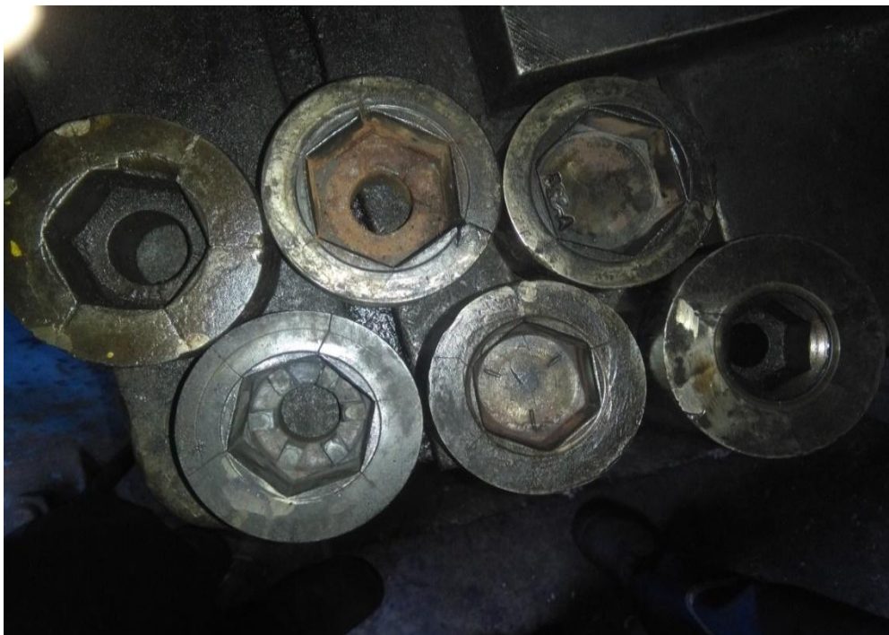
Figura n° 3-20 moldes dañados acero 4140
