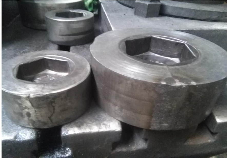
Figura n° 3-19. Moldes presentan soldadura acero 4140
